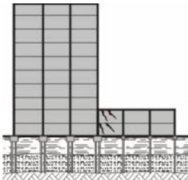
Figura 47: Danos provocados pelo carregamento não constante
