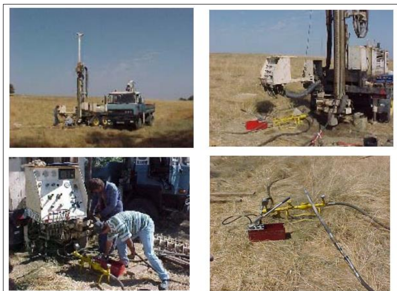
Figura 9: Ensaio de permeabilidade Lugeon
