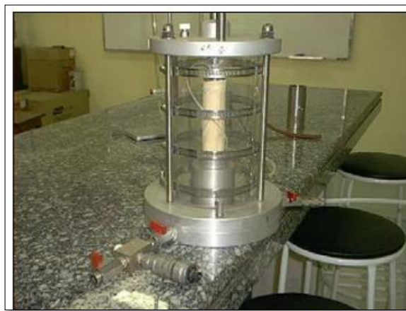
Figura 12: Ensaio de compressão triaxial
