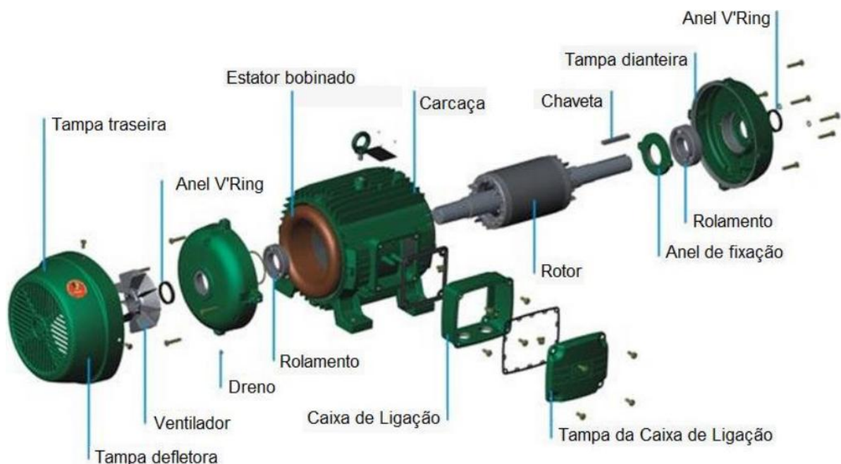
Figura 2 – Ilustração do motor de indução trifásico [8].
