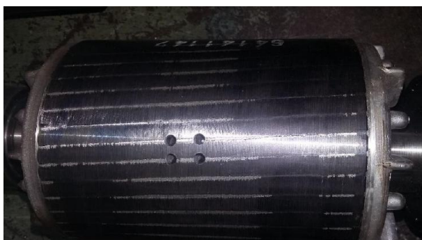
Figura 23 - Modificação física efetuado rotor por forma a obter a avaria designada por barras partidas
