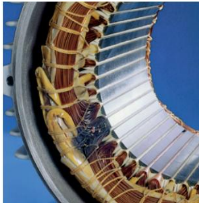
Figura 7 - Exemplo de motor queimado por pico de tensão [14]
