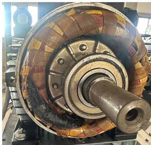
Figura 29 – Fotografia do curto-circuito nos enrolamentos do moto A
