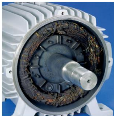
Figura 8 - Exemplo de motor queimado por rotor travado [14]
