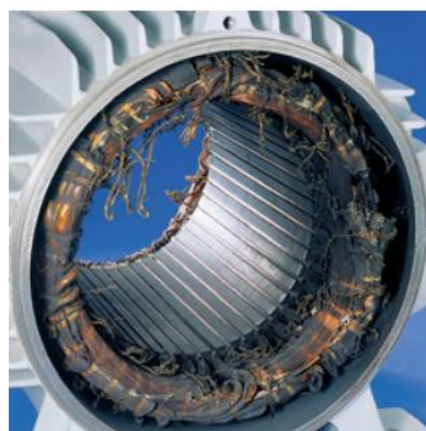
Figura 6 - Exemplo de motor queimado por sobreaquecimento [14]
