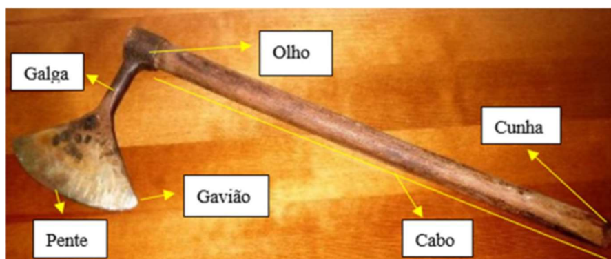
Figura 19- Machado ou machada corticeira (autoria própria)
