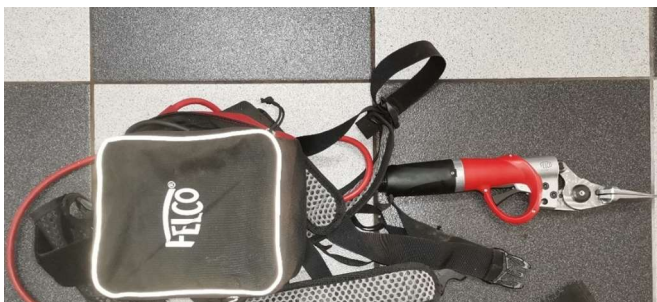
Figura 17- Felco 822+ com Pinças de descolagem (autoria própria)
