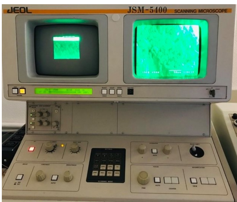
Figura 7- Microscópio Electrónico de Varrimento (Cmicros) da Egas Moniz, CRL, no equipamento JEOL LSM 5400.
