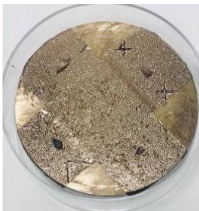
Figura 8 - Amostras colocadas em fita adesiva de carbono em base metálica.
