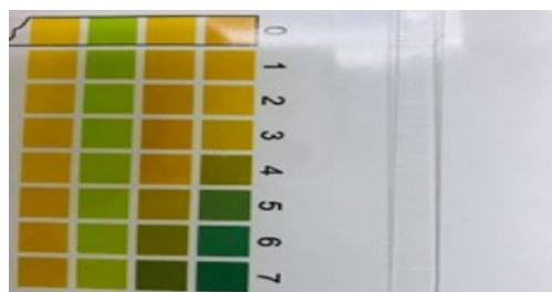
Figura 17 - Controlo de pH do ensaio A1.1, valores obtidos entre 3-4
