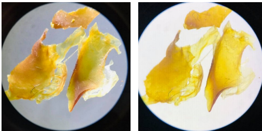
Figura 26– Amostras do Grupo A1.6 (GTA 24h) em estereomicroscópio didático Leica EZ4D a 25x, imagens iguais com diferente densidade de luminosidade. Amostras de coloração amarelada zonas de diferentes opacidades e aspeto irregular
