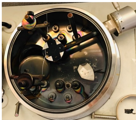
Figura 9- Instrumento de evaporação a vácuo JEOL 400, Cmicros Egas Moniz CRL.
