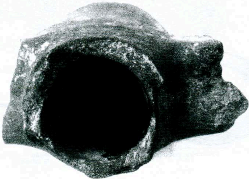
Tubeira do forno de fundição
