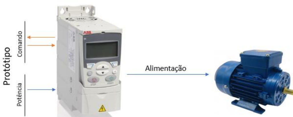
Figura 63 – Montagem do VV com o motor e os sinais de pot. e com. [39].
