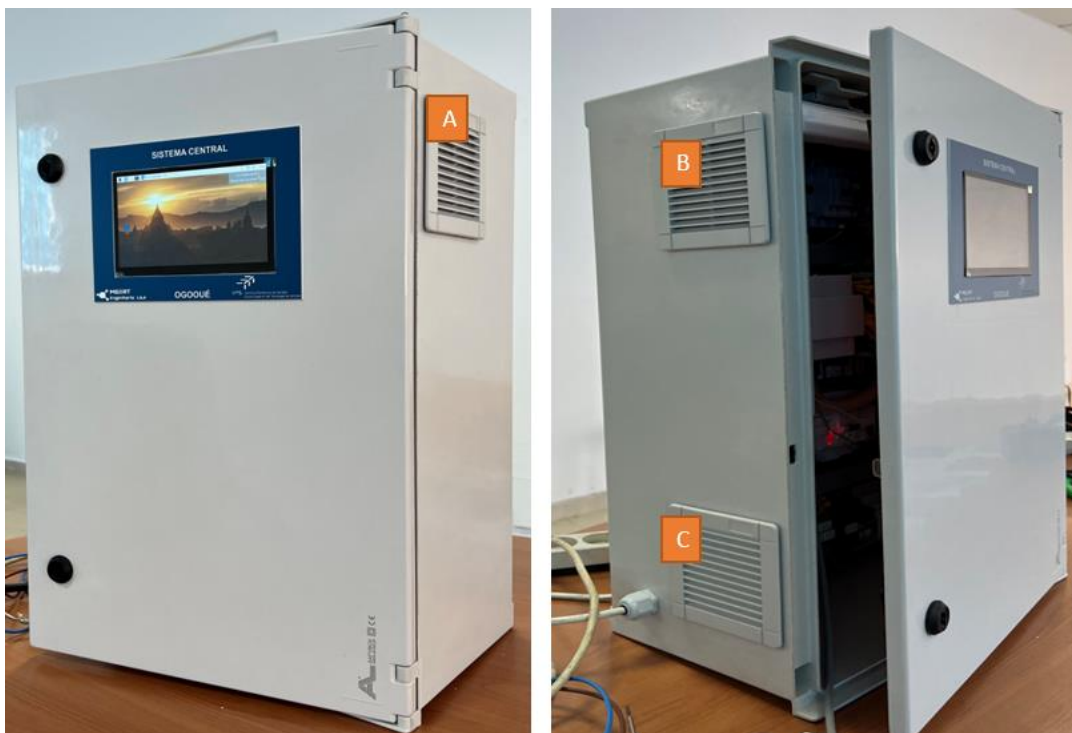
Figura 69 – Ventilação do quadro.
