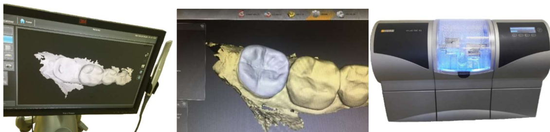
Figura 2: Constituintes dos sistemas CAD/CAM ( Scanner intraoral; Software - CAD; Fresadora - CAM).
