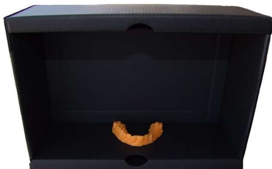
Figura 12: Caixa preta usada para a leitura dos scanners .
