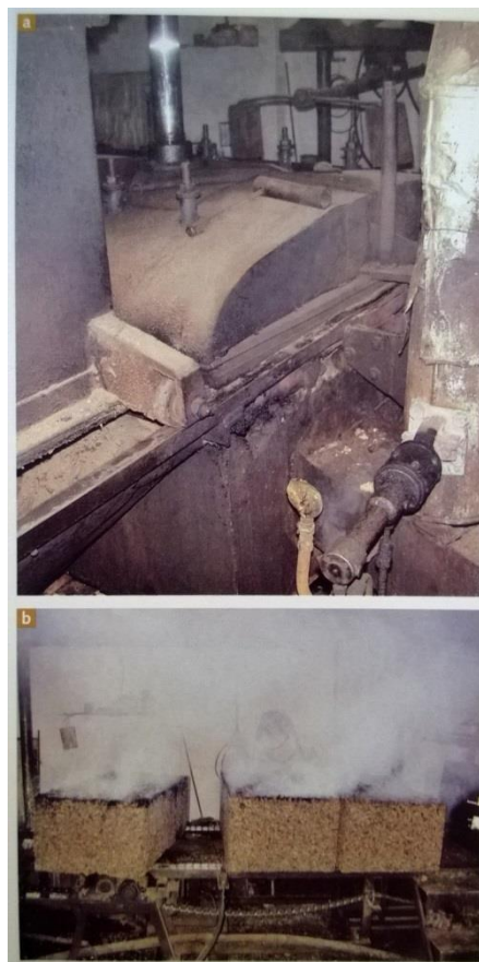
Figura 38 - (a) Autoclave para produção de aglomerado negro de cortiça; (b) Blocos de aglomerado negro de cortiça à saída da autoclave.
