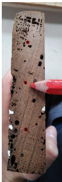
Fig.230 Pormenor dos pontos de perfuração incisos pelos pinos de marcação na peça original
