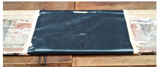
Fig.182 Paineel central do embasamento envolvido em manga de polietileno para evaporação lenta do solvente
