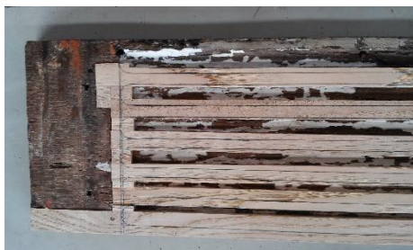
Fig. 254 Desenho para entalhe a goivas e formões
