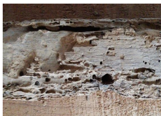
Fig. 73 Pormenor de um elemento do retábulo em mau estado conservação em resultado da ação dos insetos xilófagos
