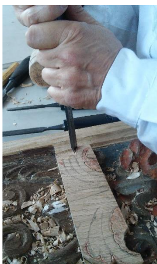
Fig.244 Pormenor da modelação volumétrica da madeira de preenchimento, através da técnica de entalhe – fase de recorte das formas e desbaste grosso
