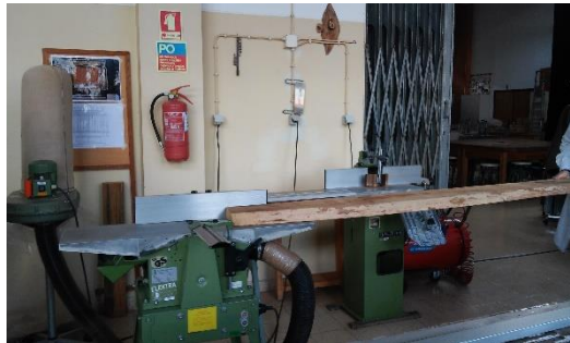
Fig. 193 Aparelhamento da prancha em madeira de castanho na garlopa-desengrossadeira,
