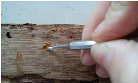
Fig.181 Verificação da eficácia da consolidação, em profundidade, por acção mecânica com ponta metálica, em peça desbastada em cerca de 3mm, após aquele procedimento.
