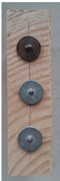
Fig.229 Pormenor dos pinos de marcação do posicionamento dos furos para garantir o alinhamento correto das perfurações nos topos das peças a unir.
