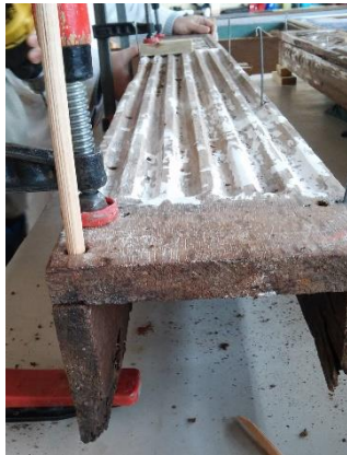
Fig.208 Ensaio das uniões das peças para preparação das colagens
