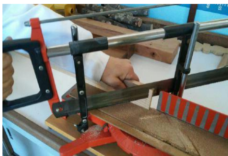
Fig. 225 Corte em esquadria do topo de uma peça de preenchimento, com a de serra de esquadrias manual
