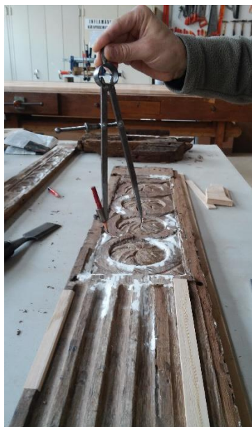
Fig.184 Medição com compasso para reproduzir desenho rigoroso na madeira nova
