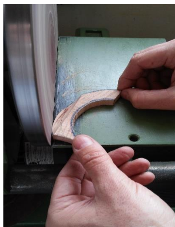
Fig. 187 . Desbaste e acerto do recorte circular, na lixadeira de disco
