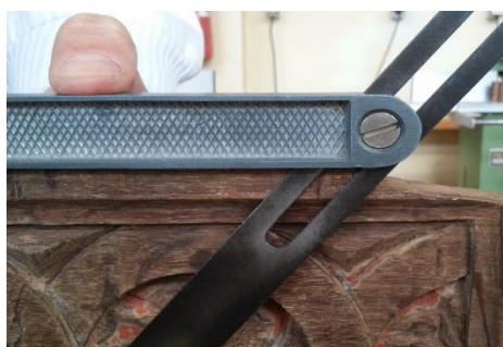
Fig. 223 Utilização da suta para obtenção de ângulos corretos
