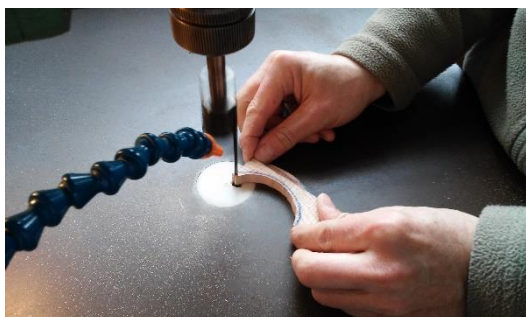
Fig.186 Recorte circular do elemento de preenchimento de uma lacuna da madeira, na serra de vazar tico-tico
