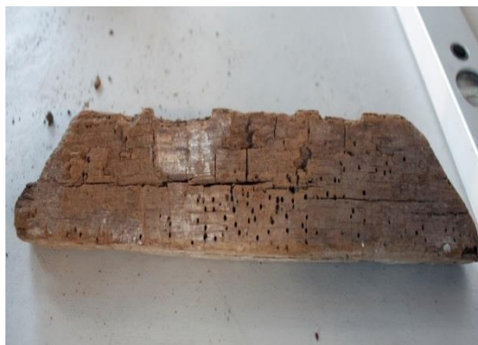
Fig. 82 Friso do embasamento com podridão cúbica
