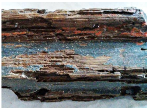
Fig.164 Ação de insetos xilófagos; lacunas da madeira e do estrato pictórico (repinte)
