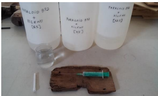
Fig.179 Procedimento de consolidação com solução de Paraloid B72 em Xileno a 6%; 8% e 12%, aplicada a seringa nos orifícios de eclosão e galerias criadas pelos insetos xilófagos
