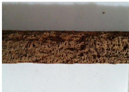
Fig. 78 Elemento estrutural do retábulo sem resistência física e mecânica devido à biodeterioração – a ação dos insetos xilófagos e a podridão cúbica – causada pelos altos índices de humidade
