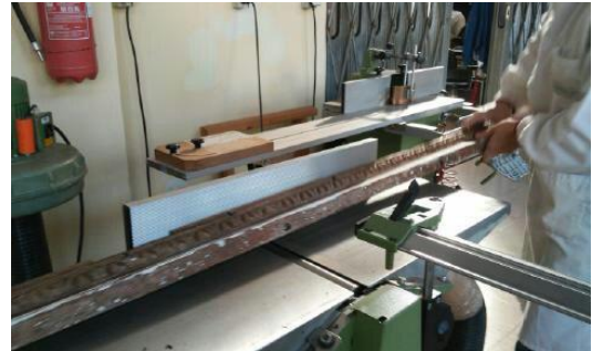
Fig. 201 Ablação, por desbaste, da madeira deteriorada do friso – com lacunas e sem resistência mecânica – pela ação de fungos lenhívoros e insectos xilófagos, para preenchimento com madeira
