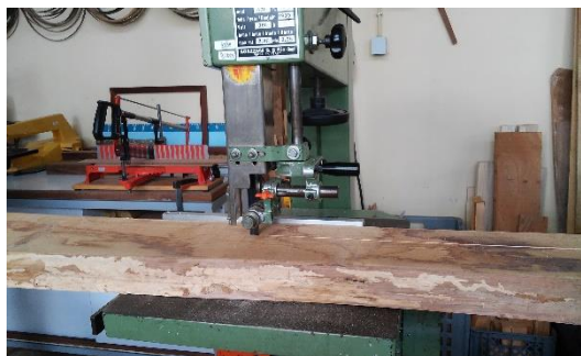
Fig. 192 Corte longitudinal de uma prancha em madeira de castanho, na serra de fita
