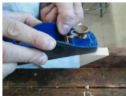
Fig.226 Nivelamento e acerto de peça para preenchimento de lacuna com plaina de topos
