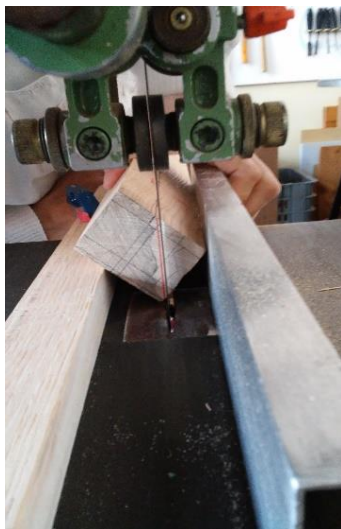
Fig. 194 Corte longitudinal do excedente da peça reconstituição de um friso em madeira, na serra de fita
