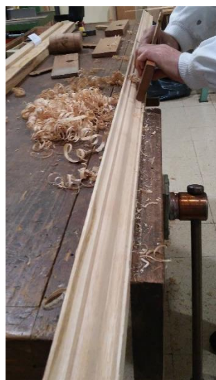
Fig. 197 Modelação manual do perfil do friso a reconstituir, com ferros planos e curvos
