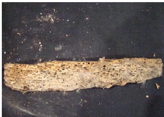
Fig. 63 Elemento de fixação do suporte sem funcionalidade
