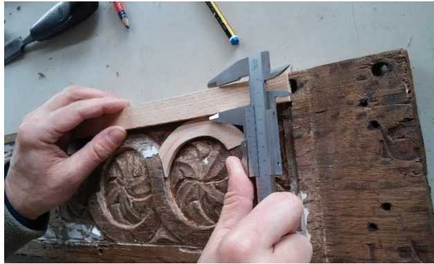
Fig. 39 . Utilização do paquímetro para medição rigorosa da espessura
