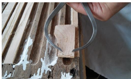
Fig.252 Utilização do compasso para marcação rigorosa do desenho
