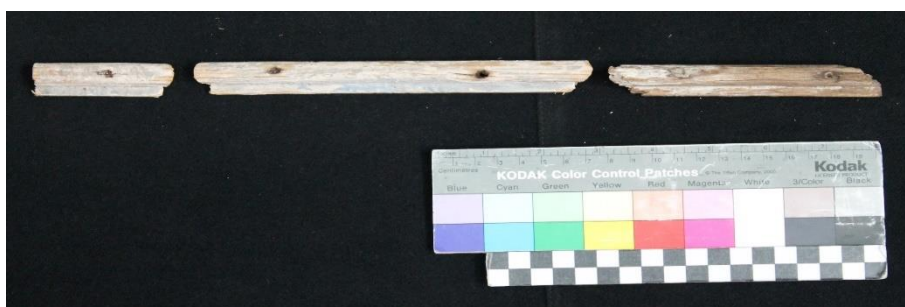
Fig. 106 Vista geral do conjunto das tábuas que constituem a estrutura de fixação da tela, pelo verso
