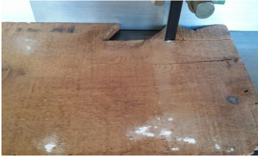
Fig. 198 .Ablação de madeira deteriorada, de uma tábuia do painel central de fixação da tela, para posterior preenchimento com madeira, de modo restituir a resistência mecânica e permitir a sustentação na armação onde será montada
