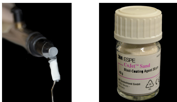
Figura 17 - Jato Airsonic Mini Sandblaster (Hager & Werken, Duisburg, Germany) com arame ortodôntico a 10mm e partículas de óxido de alumínio silicatizadas CoJet TM Sand (3M ESPE)
