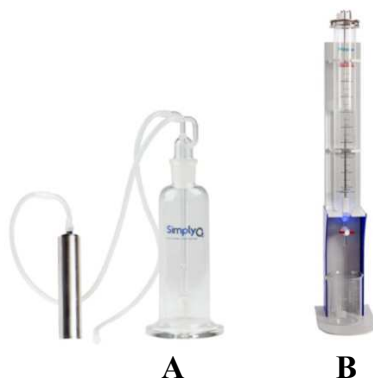
Figura 11 - Sistemas de ozonização de água utilizados: A - Sistema borbulhador de água (SimplyO 3 , Grand Ledge, USA); B - Coluna de ozonização de água (Philozon, Nova Esperança, Brazil).
