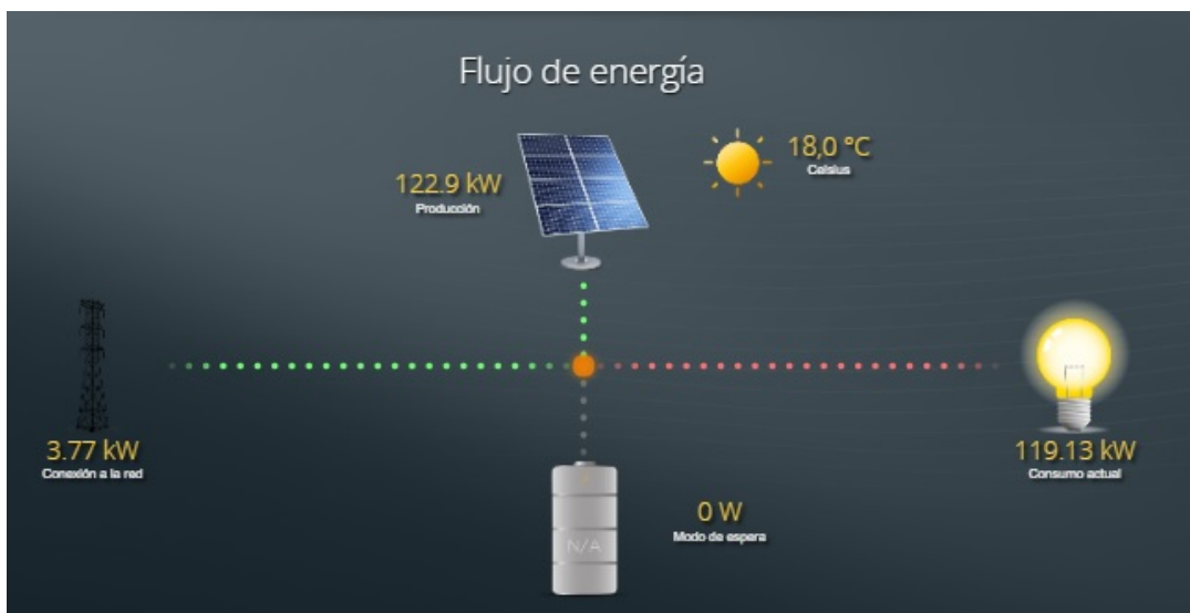
Figura 7.8 - Fluxo de energia verificado no site SolarLog
