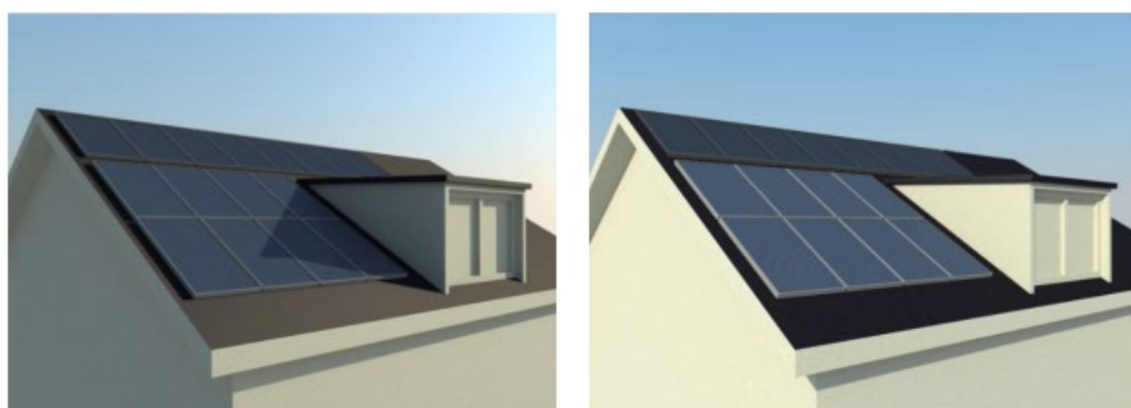
Figura 3.24 – Sistema fotovoltaico com e sem sombreamento consoante diferentes horas do dia. (SMA Solar Technology AG, 2018).
