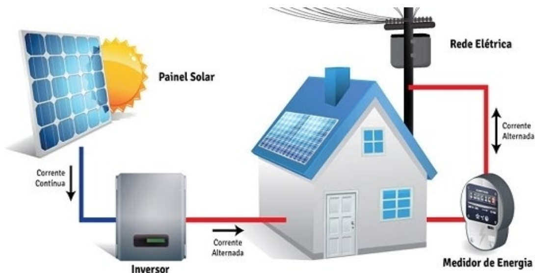
Figura 3.31 - Sistema com ligação à rede (csrenergiasolar, 2017)
