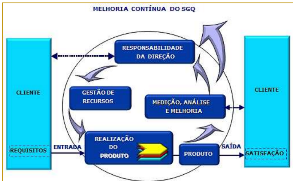
Figura 3.2: Modelo para a abordagem por processos definida na ISO 9001:2000 [2].
