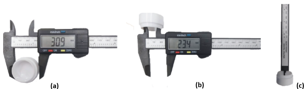
Figura 4.4: Imagem de um paquímetro. Figura (a) - medição de exteriores utilizando as maxilas inferiores; Figura (b) - medição de interiores utilizando as maxilas superiores; Figura (c) - medição de profundidades com a haste de profundidade. Adap.[14].
