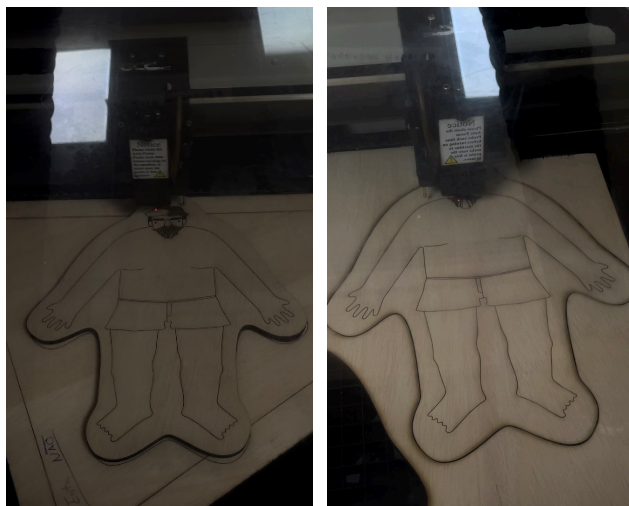
Figura 28. Gravação a laser da ilustração
