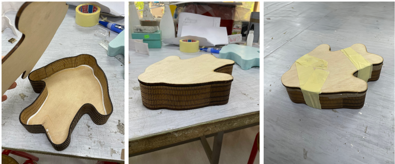
Figura 29. Processo de colagem da caixa
