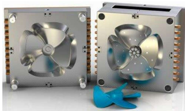
Figura 18. Molde de injeção plástica e peça produzida.
