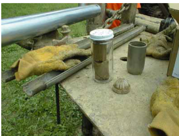
Figura 109 – Ensaio SPT – Amostra. (12)
