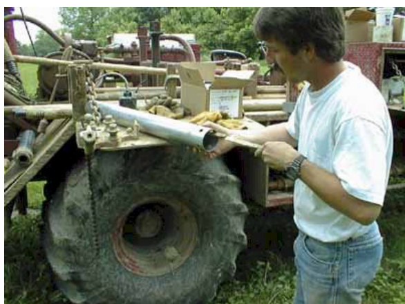
Figura 110– Ensaio SPT Medição da Penetração no sol.(12)
