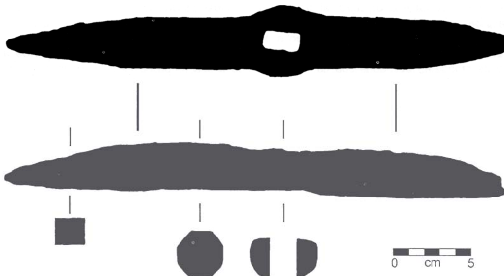
Fig. 8 — Pico para reavivar os dentes das mós.
