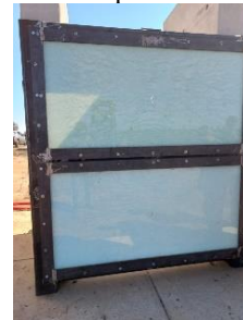
Fig. 8. Set-Up ensaiado com carga de 5kg@9m
