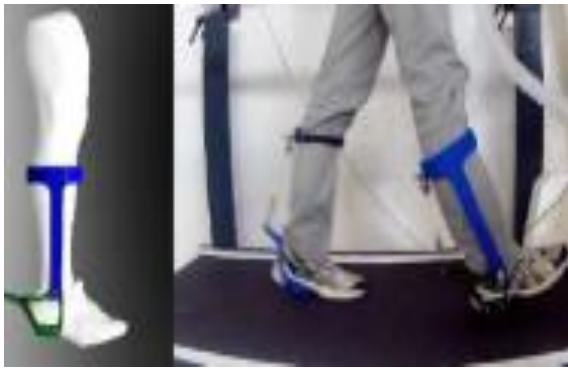
Fig. 1. Exosqueleto Passivo de tornozelo. Fonte: Ribeiro et al., 2021.
