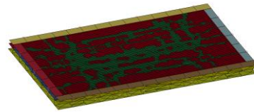
Fig. 7. Início da rotura do painel de vidro com uma carga de 5kg@7m.
