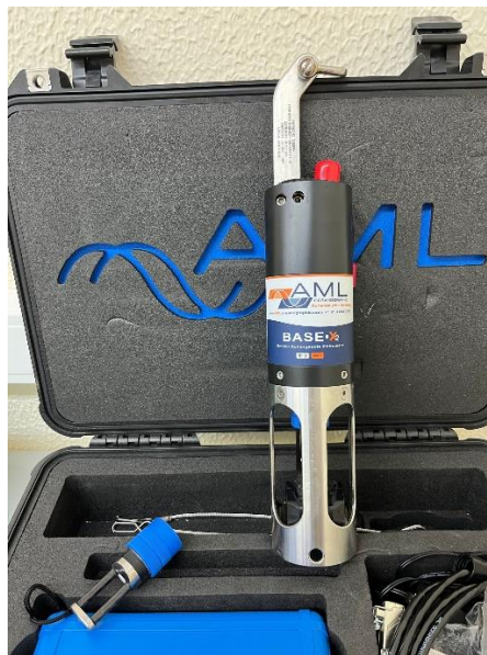
Figura 6- Equipamento utilizado no trabalho com capacidade CTD e SVP.
