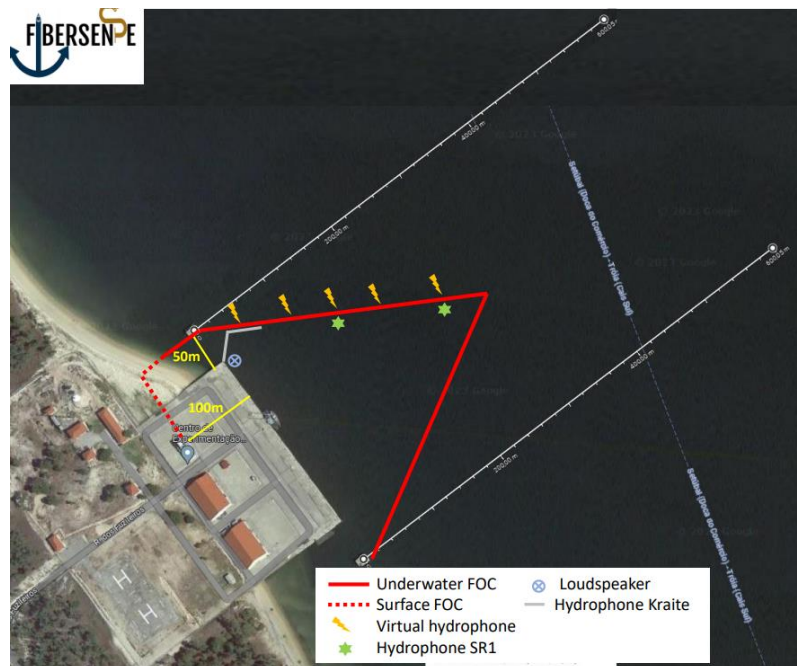
Figura 46- Zona de operação e configuração esquemática da implementação.
