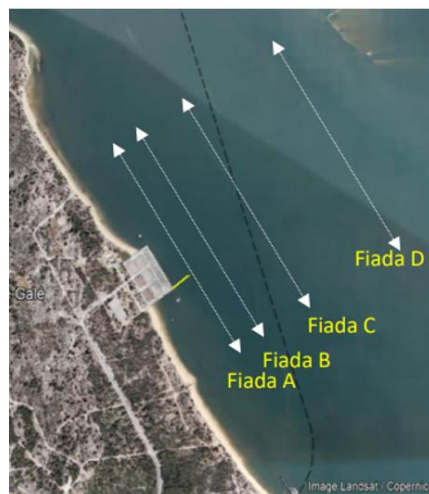
Figura 43- Zona de operação, incluindo as fiadas previstas
