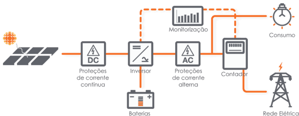
Figura 10 - Processo de instalação de um sistema fotovoltaico [51].
