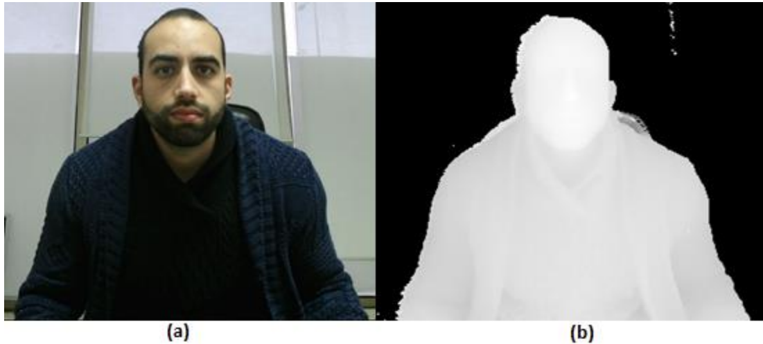
Figura 10 (a) Exemplo de imagem RGB (b) representação em imagem da informação de profundidade
