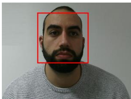
Figura 21 Representação das coordenadas da face detetadas com o OpenCV
