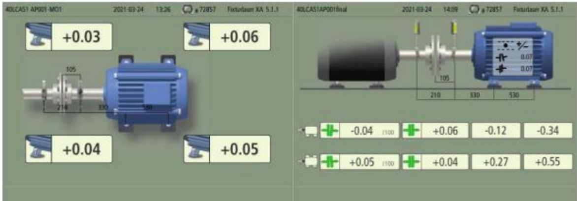
Figura 90 - Condição de final de “pata-coxa” do motor ((do lado esquerdo) e Condição de alinhamento final motor/bomba (do lado direito) [24].
