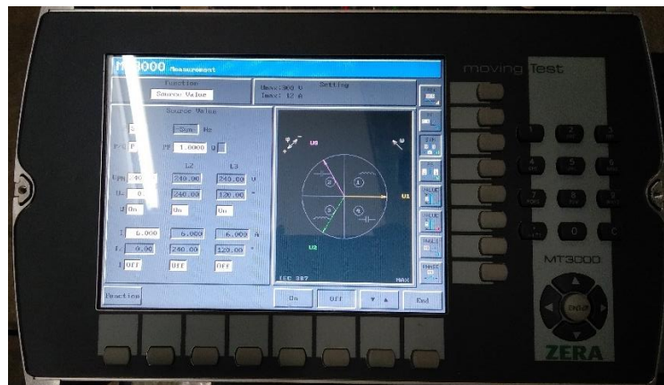
Figura 64 - Ângulo de desfasamento 120^\circ das tensões.
