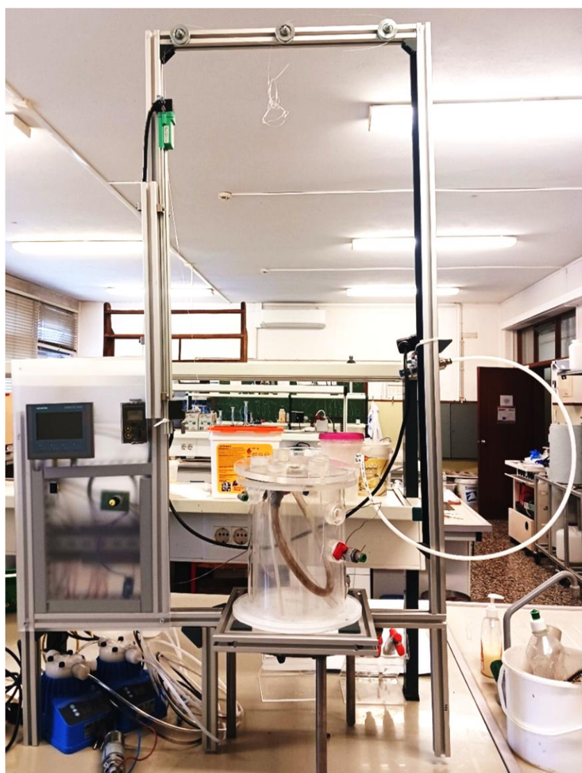
Figura 3.1 – Reator anaeróbio automatizado.
