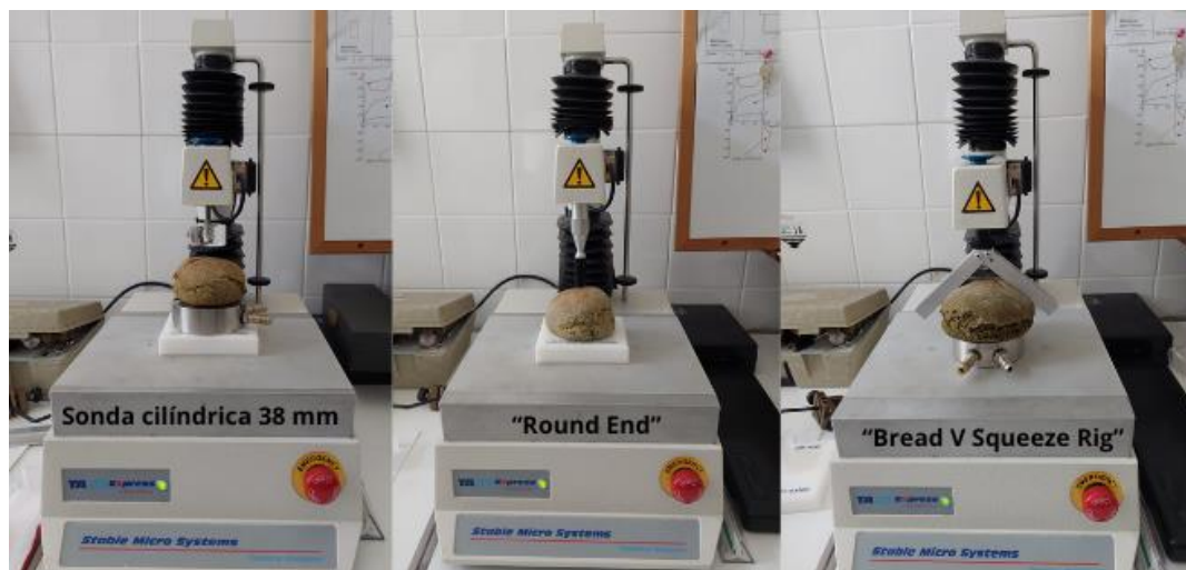
Figura 30 – Sondas utilizadas na análise do perfil de textura do pão
