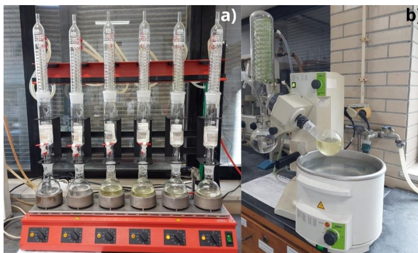
Figura 51 – a) Aparelho de Soxhlet; b) Evaporador rotativo
