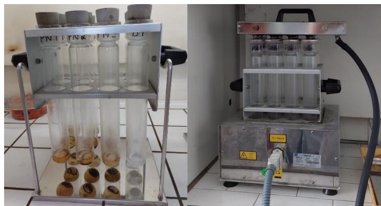
Figura 55 – Tubos Kjedhal antes e depois de serem colocados no digestor (da esquerda para a direita, respetivamente)
