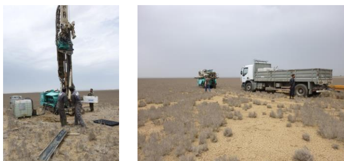
Figure 7 : Prélèvement de la carotte SK10-C1 avec le carottier Technidrill dans la sebkha Kalbia (référence inconnue)
