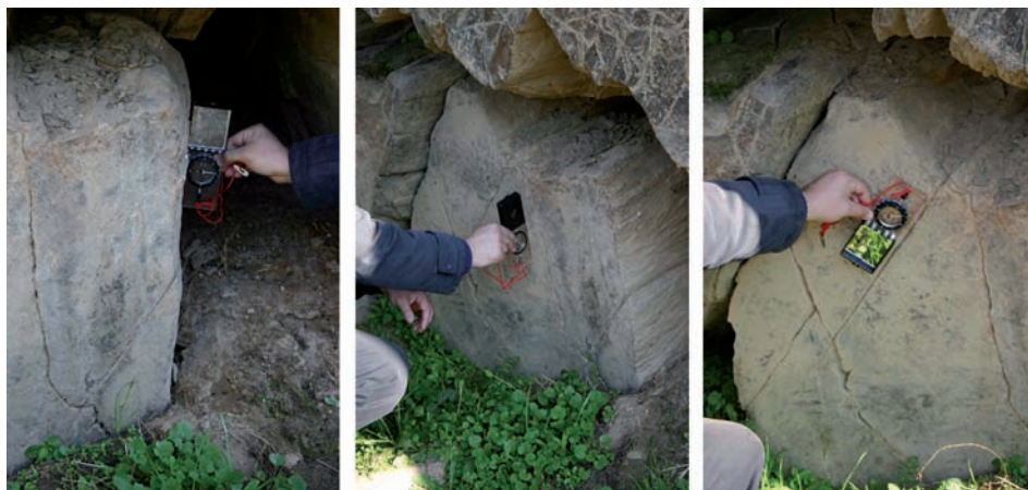
fig. 21 Medição de atitudes de diaclases nos blocos (B1), (B2) e (B3).
