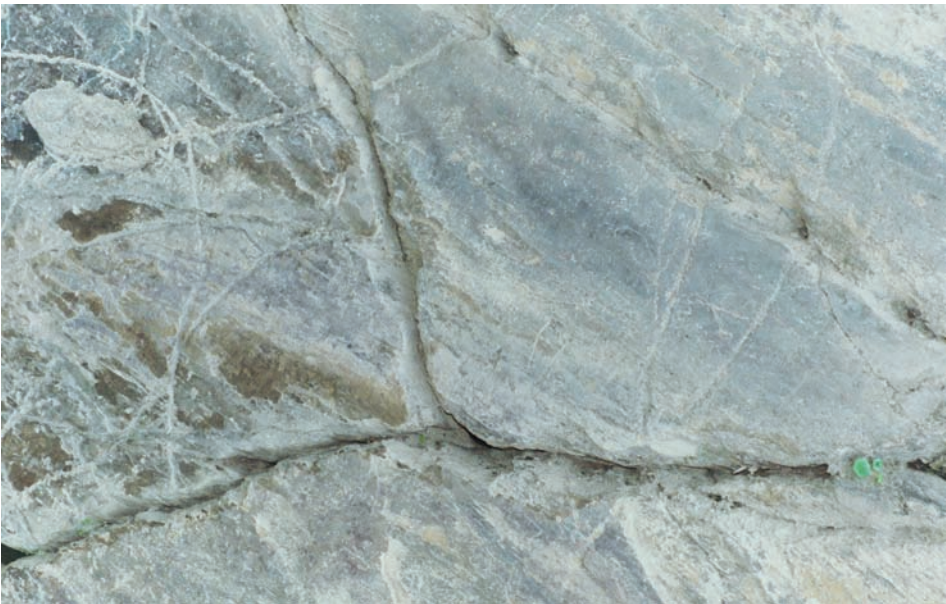
fig. 18 Pormenor de diaclasses com várias direcções.
