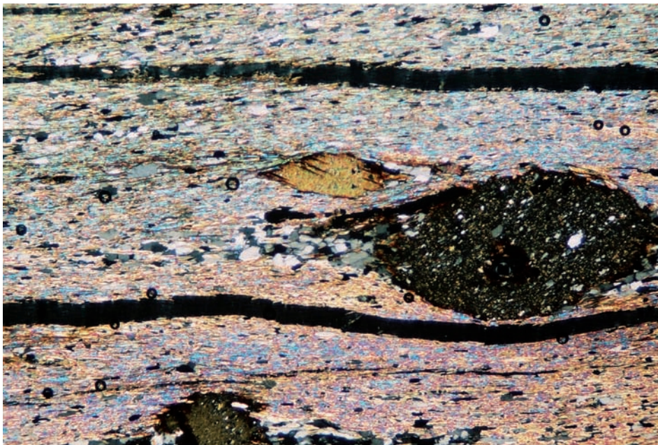
fig. 10 Aspecto geral do filito de textura porfiroblástica, cristal de biotite ladeado por agregados de cristais de Quartzo. Observação em luz polarizada (LP) da amostra FCAM1 – Rocha 5.
