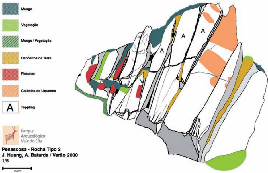
fig. 19 Cartografia das formas de degradação da rocha 3 realizada em CorelDRAW.
