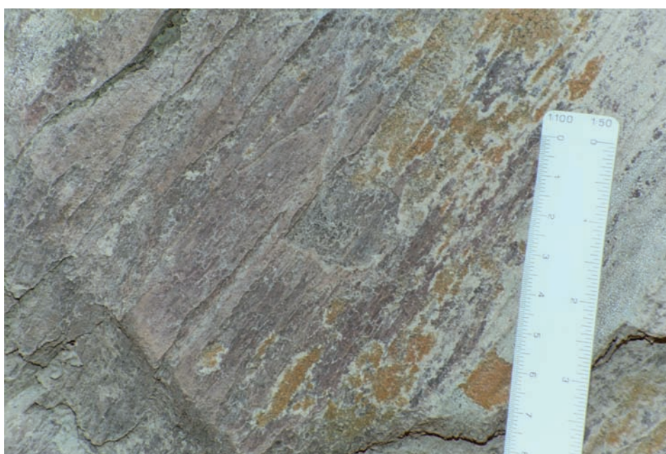
fig. 15 Pormenor da presença de líquenes e de fenómenos de picadura à superfície de uma rocha.
