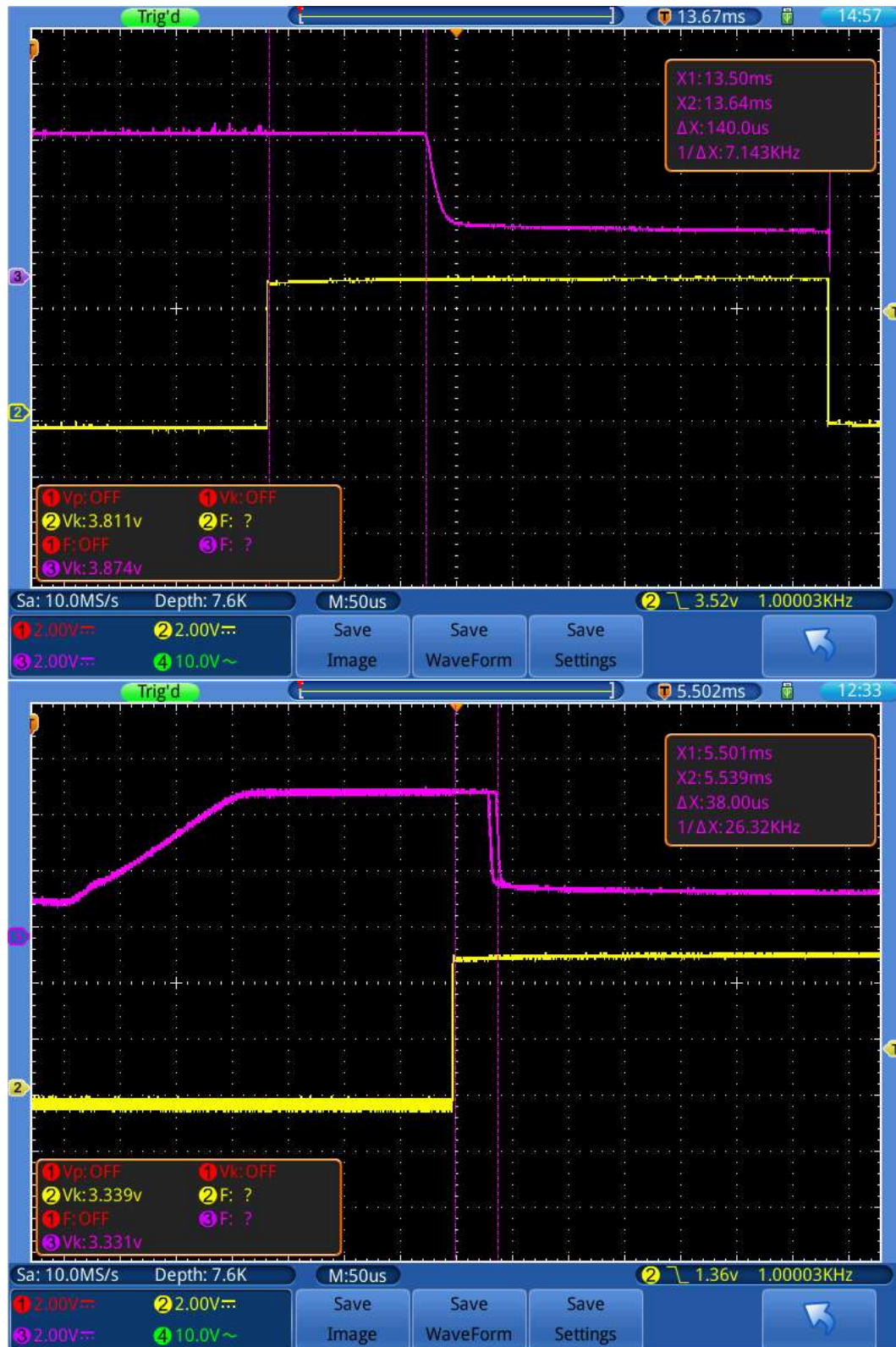
Figura 50 – Formas de onda registadas no desligar do interruptor, a uma frequência de 1000Hz. Na eurocard obsoleta o interruptor desliga em 140 \mu s (à esquerda) enquanto na eurocard nova o interruptor desliga em 38 \mu s (à direita), (osciloscópio do laboratório da CP).
