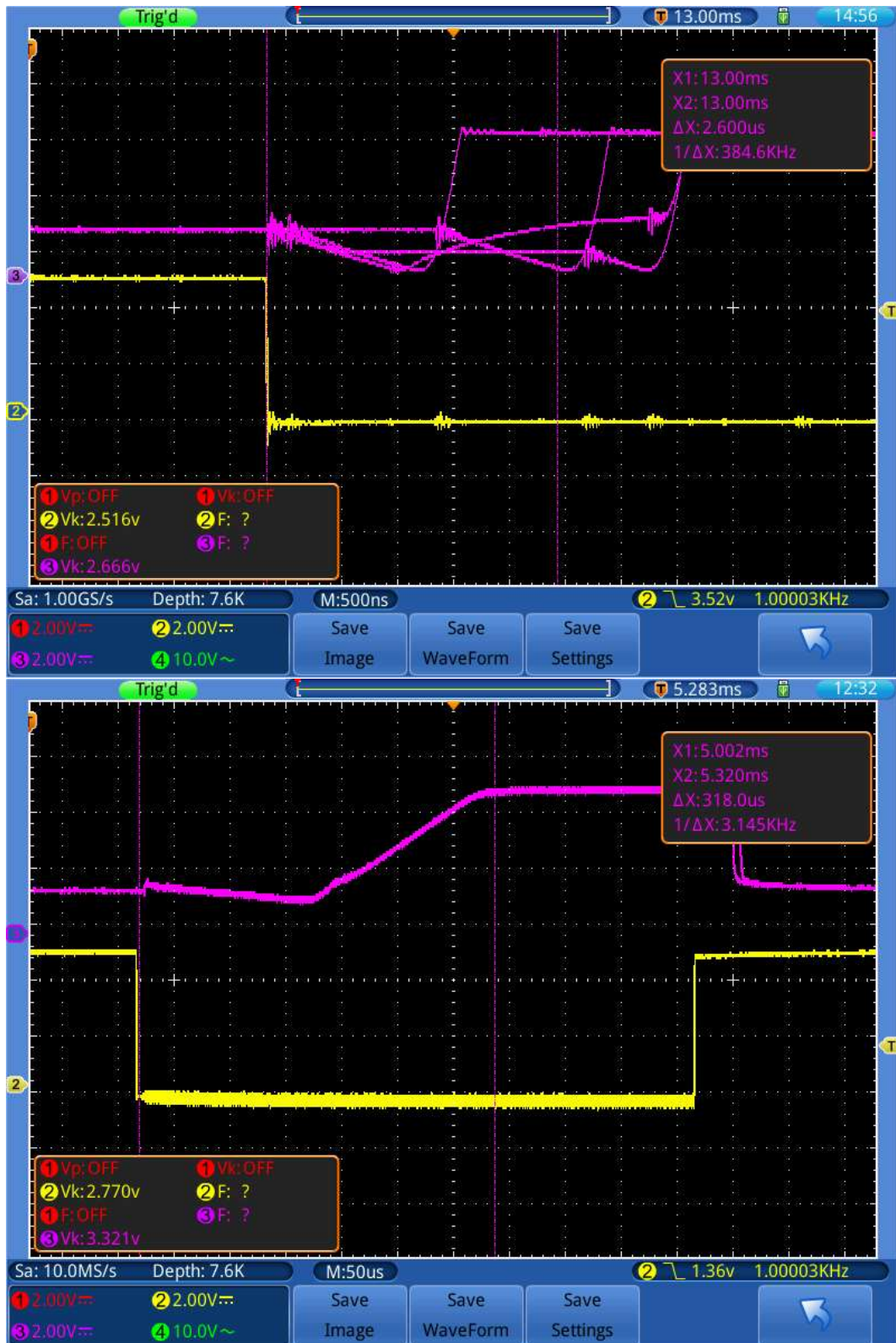
Figura 49 – Formas de onda registadas no ligar do interruptor, a uma frequência de 1000Hz. Na eurocard obsoleta o interruptor liga em 2,6μs (à esquerda) enquanto na eurocard nova o interruptor liga em 318μs (à direita), (osciloscópio do laboratório da CP).
