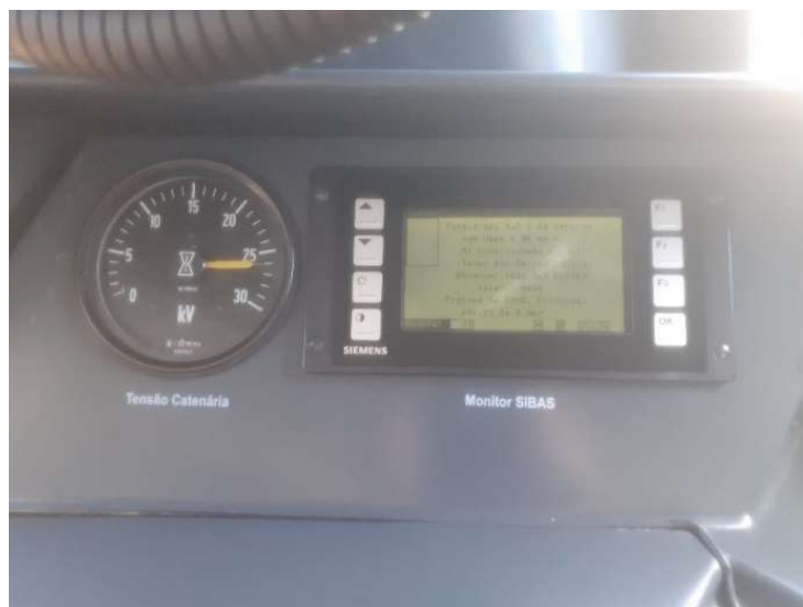
Figura 59 – Mostrador analógico da tensão da catenária (à esquerda) e monitor SIBAS (à direita) no painel de comandos da UQE 2403/63 (foto no parque oficial de Campolide).
