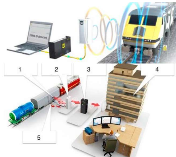
Figura 17 – Esquema de operação da tecnologia RFID no transporte ferroviário: 1 — codificador integrado; 2 — unidade de leitura na infraestrutura; 3 — hub de dados; 4 — centro de processamento de dados da empresa; 5 — sensor de passagem da roda (Popova, et al., 2021).
