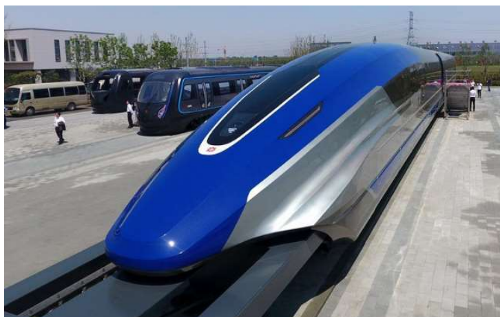
Figura 13 – Protótipo de comboio maglev projetado pela China em 2019, para atingir velocidades na ordem dos 600km/h (Xinhua photo: https://news.cgtn.com/news/3d3d514f3163444f34457a6333566d54/index.html )
