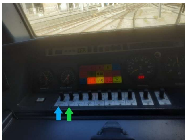
Figura 60 – Visão parcial do painel de comandos na UQE 2403/63: interruptor de alavanca de acionamento do pantógrafo (assinalado pela seta azul) e interruptor de alavanca de acionamento do disjuntor principal (assinalado pela seta verde), (foto no parque oficial de Campolide).
