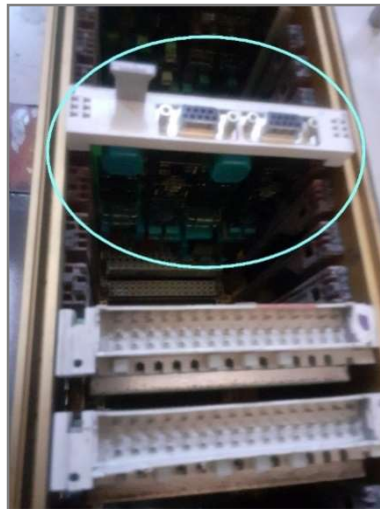
Figura 25 – Eurocard 6FH8163 inserida no rack da UCC de uma UQE 2300/2400 (foto nas instalações da CP).
