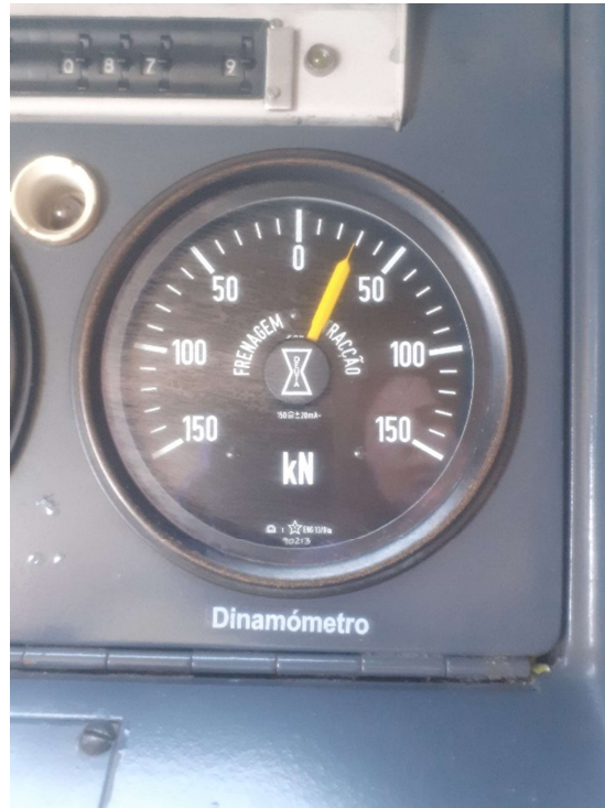
Figura 62 – Mostrador analógico do dinamómetro da UQE 2403/63, com uma tração aplicada de cerca de 30kN (foto no parque oficial de Campolide).
