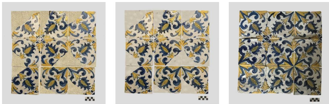
Figura 13 Azulejo de padrão Maçaroca utilizado para a realização do questionário. O primeiro apresenta o preenchimento em argamassa de areia e cal, o segundo tom do vidroado, e o terceiro reintegração mimética. Autoria: Catarina Castelo
