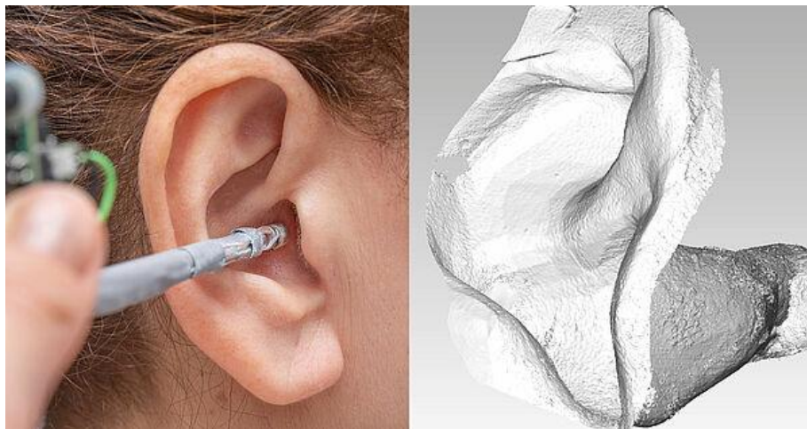
Figure 2.8 - TinyScan360° próximo do canal auditivo e reconstrução 3D de um ouvido (Fonte: AIT, 2024).
