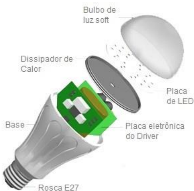
Figura 23 – Esquemático de uma lâmpada LED [18]
