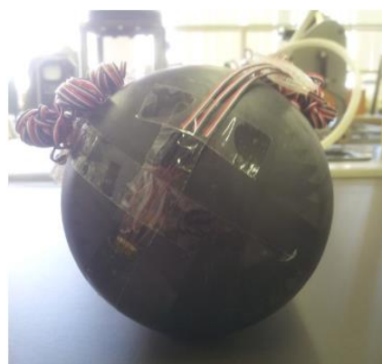
Figura 5-14: Extensômetro em corpo cilíndrico principal e extensômetro em fundo copado toriesférico, respectivamente
