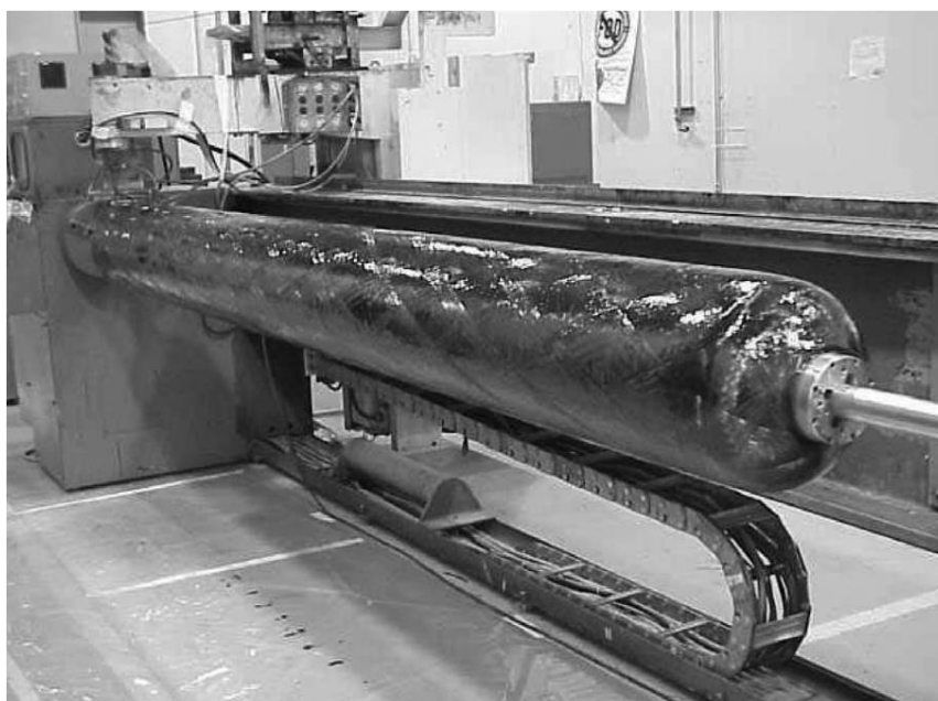
Figura 3-6: Enrolamento filamentar geodésico (Peters, 2011)
