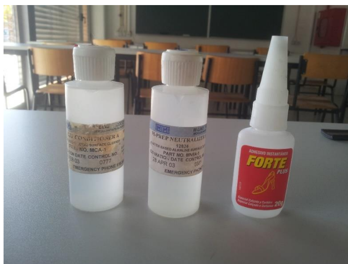
Figura 5-5: Condicionador, Neutralizador e Cola utilizada, respetivamente
