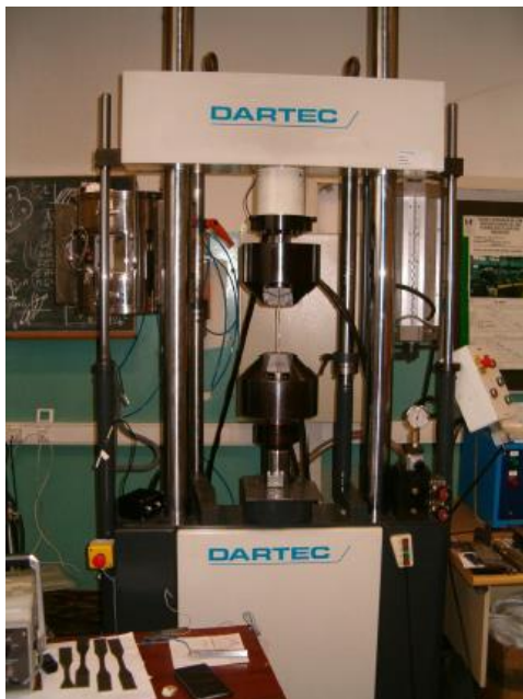
Figura 5-1: Máquina servo-hidráulica DARTEC
