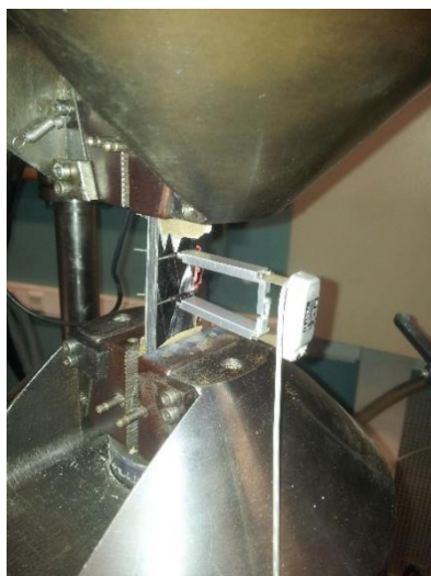
Figura 5-3: Provete a ser ensaiado com transdutor
