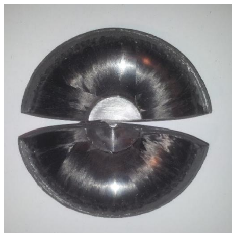
Figura 6-12: Existência de reforço metálico no fundo copado da garrafa Stako
