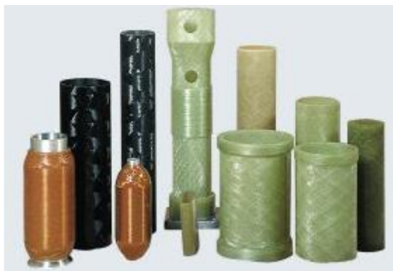
Figura 3-5: Produtos obtidos por enrolamento filamentar (Pereira, 2007)
