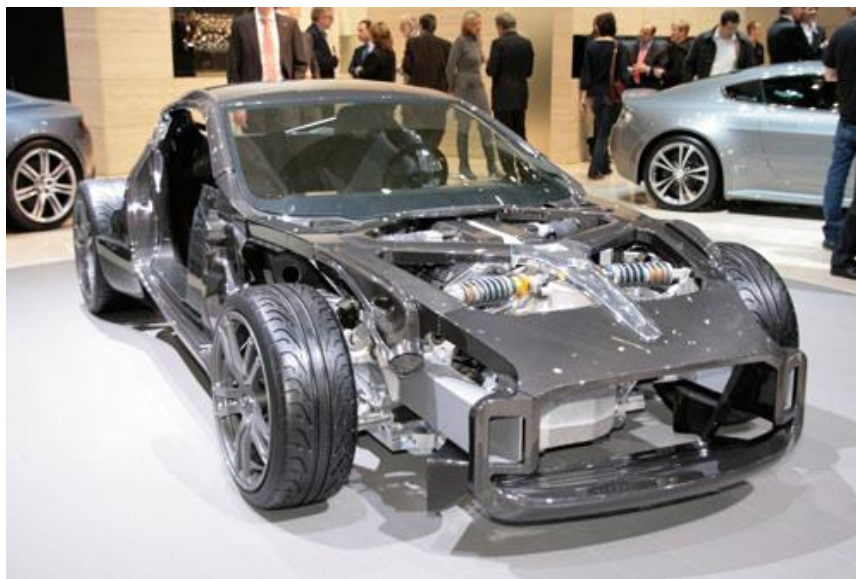
Figura 2-1: Protótipo Aston Martin Vanquish V12, composto na sua maioria por fibra de carbono
