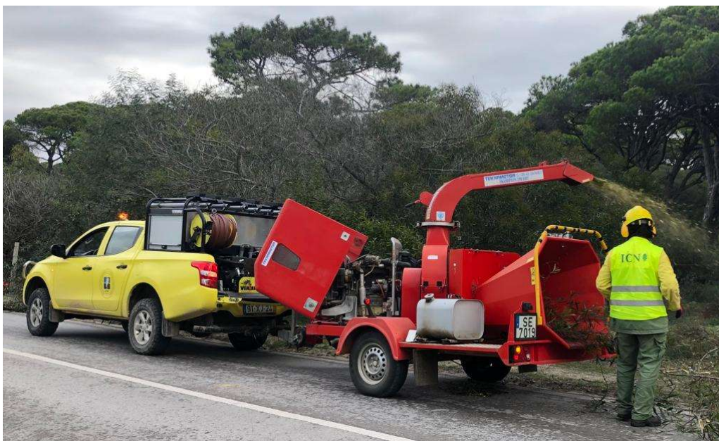
Figura 7 - Destroçamento da biomassa com recurso a biotriturador (Cuim, 2021).
