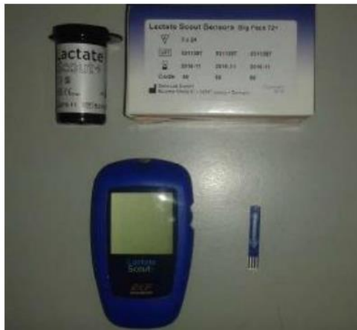
Figura 28. Analisador Portátil de Lactato (LAC) no Sangue “Lactate Scout+®” e tiras reativas “EKF Diagnostics. Fonte: Oliveira, R. (2021, p.76).
