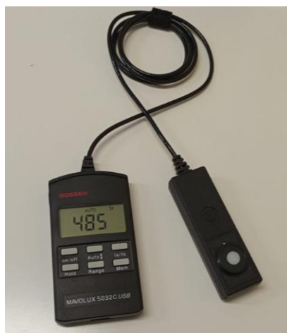
Figura 1 – Luxímetro Gossen, Mavolux 5032 C USB.
