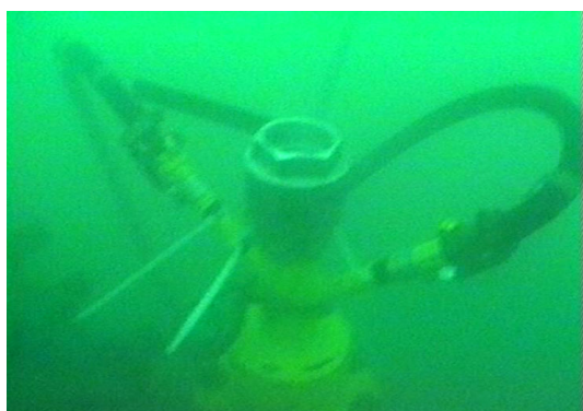
Foto I – Tampa da extremidade durante o ensaio de pressão hidrostática.
