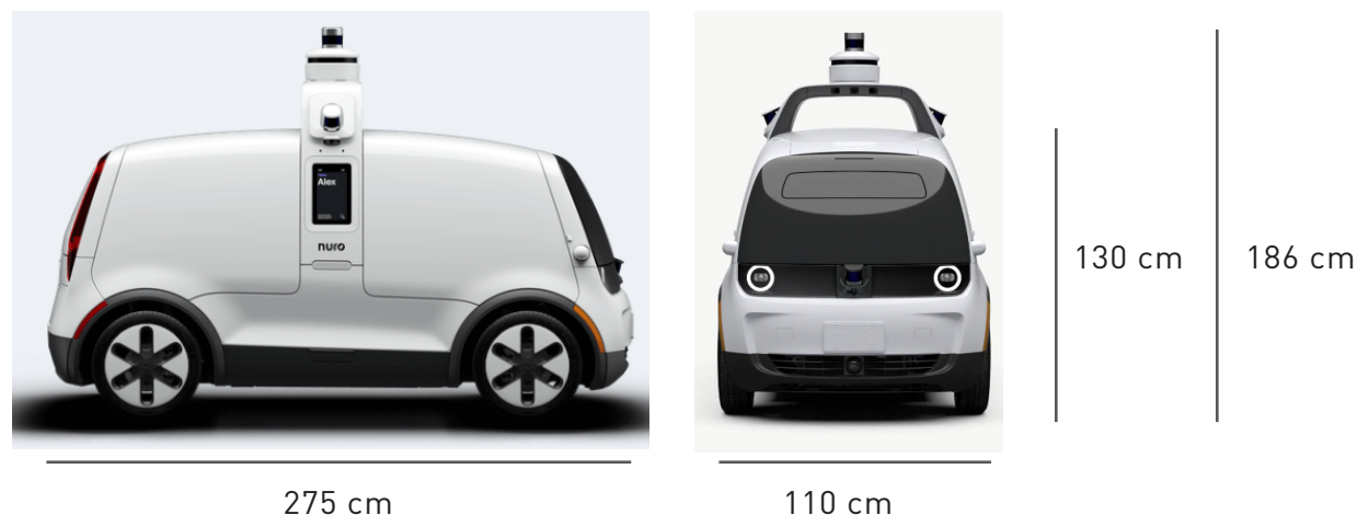
Figura 67. Dimensões veículo Nuro, estudado no benchmark. Fonte: https://www.nuro.ai/technology Autor : Nuro
