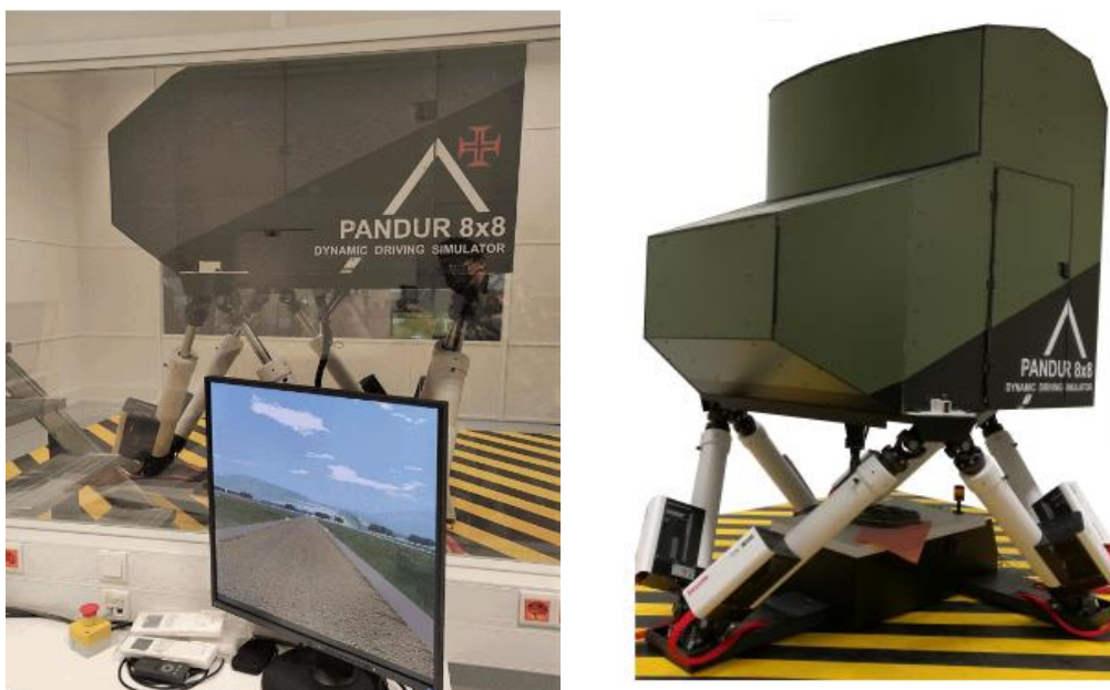
Figura 5– Sistema PDDS com estação designada ao instrutor (esquerda) e cabine e plataforma dinâmica (direita)
