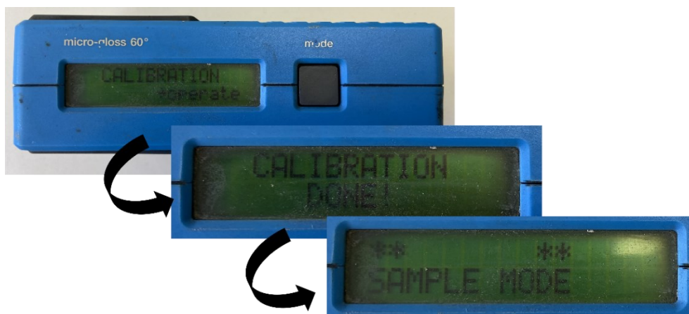
Figura 13. Etapa de calibração do Glossmeter Micro-Gloss 60° N°4501
