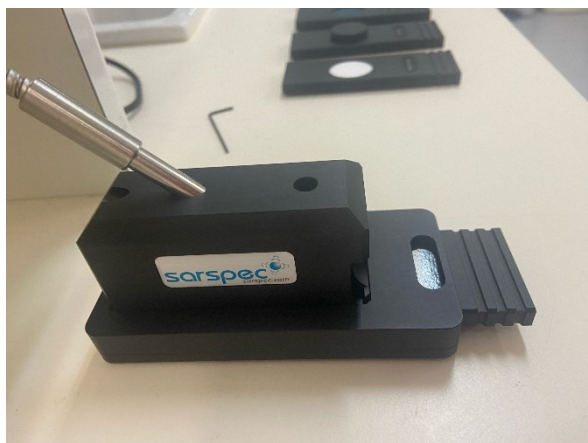
Figura 18. Montagem da fibra ótica de luz LED num ângulo de 60°
