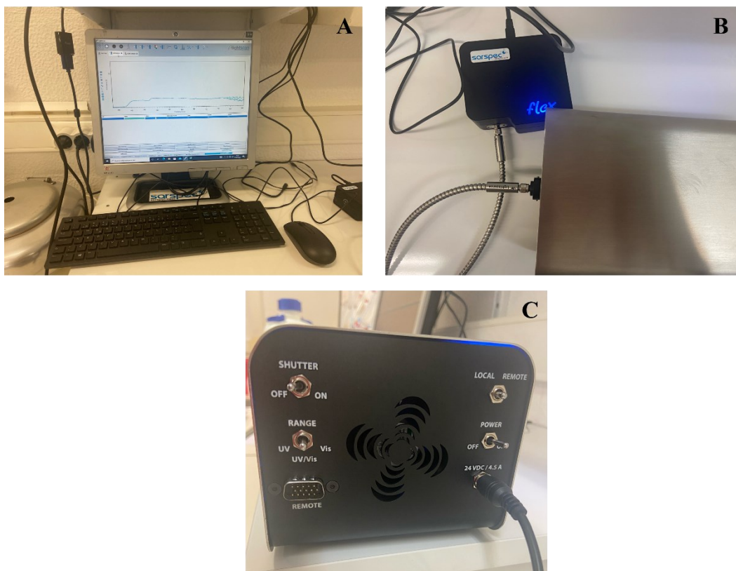
Figura 17. Medição biaxial da cor e do brilho com o SARSPEC Flex: (A) Fotografia do computador de auxílio; (B) Fotografia do diapositivo SARSPEC Flex e da fonte de luz LED (vista superior); (C) Fotografia da fonte de luz LED (vista lateral).
