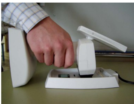
Figura 10. Calibração do espectrofotômetro SpectroShade Micro Optic. Imagem retirada de (Medical High Technologies, 2006).
