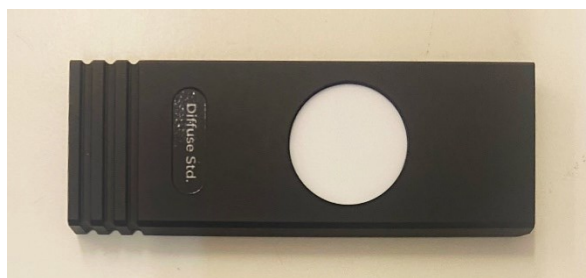
Figura 19. Peça de calibração do instrumento SARSPEC Flex
