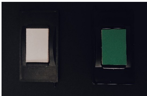
Figura 11. Fotografia dos azulejos, branco e verde, para a calibração do Spectroshade Micro Optic.
