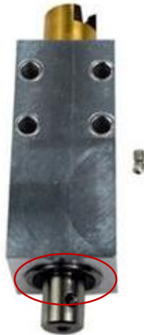
Figura 21 – Representação do fuso da fresadora de precisão e zona de manutenção
