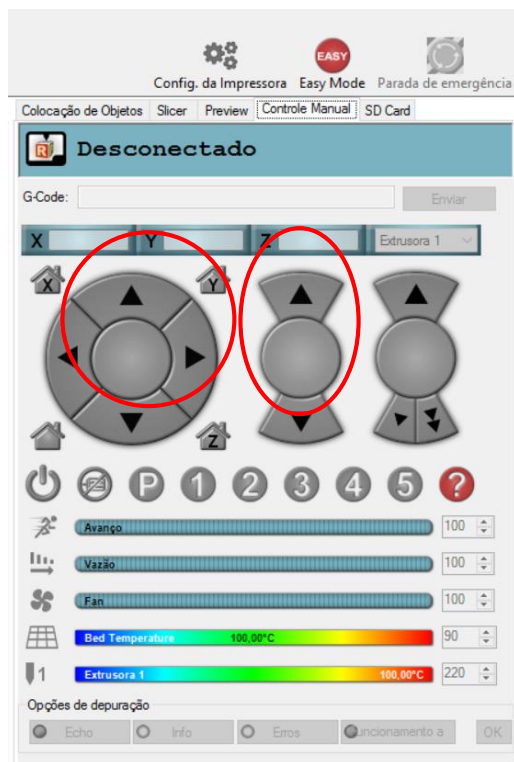
Figura 34 – Botões de movimento da plataforma e cabeça de extrusão
