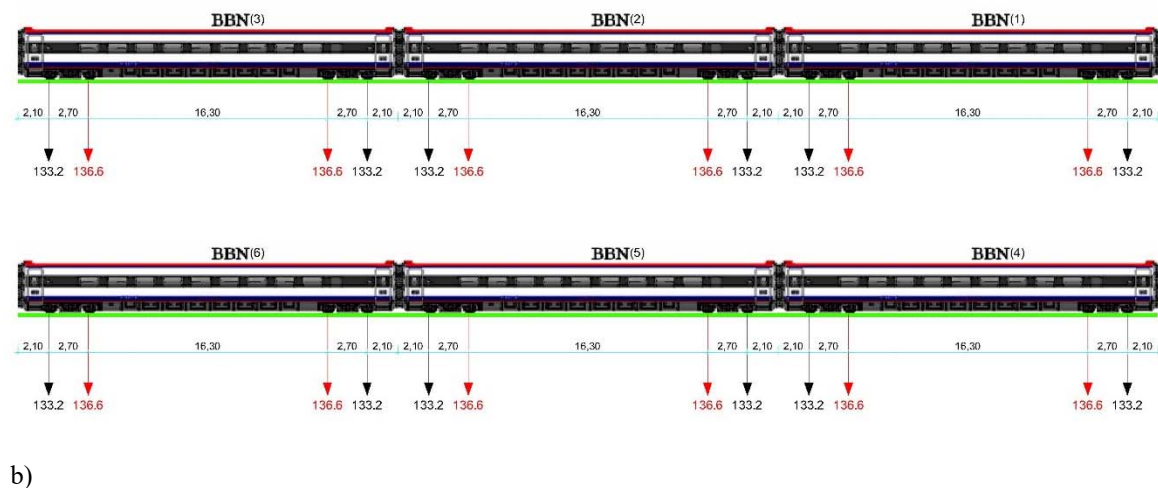
Figura 5.2: Esquema de cargas: a) comboio Alfa-Pendular (Ribeiro, 2012); b) comboio simplificado (adaptado de Ribeiro, 2012)
