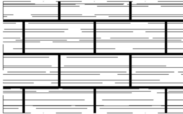
Figura 2.4: Aspeto da alvenaria de paramento ou de capeamento após o refechamento das juntas
