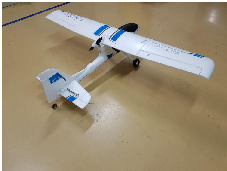
Figura 20 - Aeronave do tipo "Skywalker" em poliestireno expandido.
