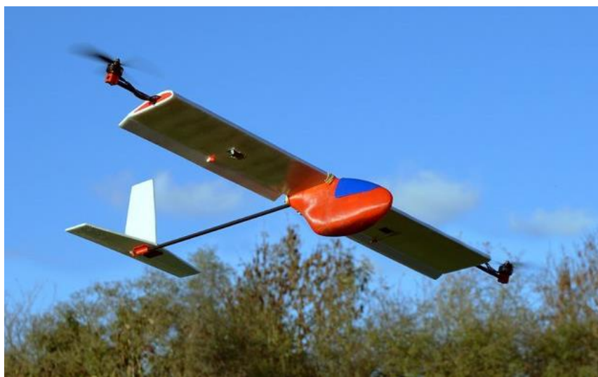
Figura 14 - Exemplo de uma aeronave homebuilt com dois motores RC VTOL (Stanton, 2018).
