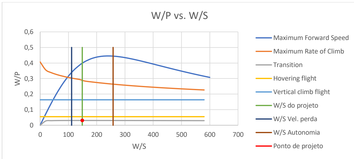
Figura 15 - Gráfico da variação de W/P em função de W/S .
