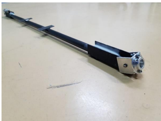
Figura 21 - Apoio com dobradiça de um dos motores frontais.
