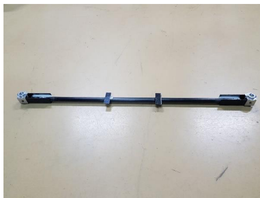
Figura 22 - Apoio em carbono para dois motores com suportes de dobradiça.
