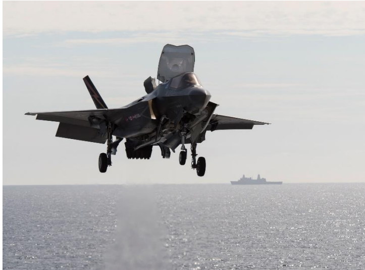
Figura 3- Aeronave Lockheed Martin F-35B a executar uma aterragem vertical (Lockheed Martin Corporation, 2019).
