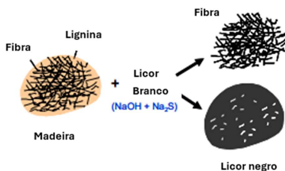
Figura 4.1– Processo de Cozimento Kraft. Fonte: Adaptado de (Vakkilainen, 2007).
