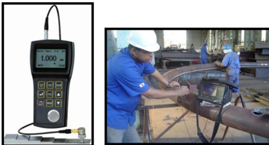
Figura 4.14 – Aplicação de análise ultrassónica. Fonte: (Barulho, 2011).
