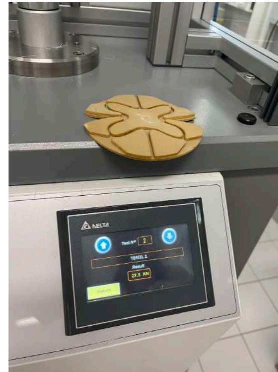
Fig. 41 - 1º Ensaio ao impacto do conceito A com o material desenvolvido no CITEVE. Realizado pelo CITEVE.
