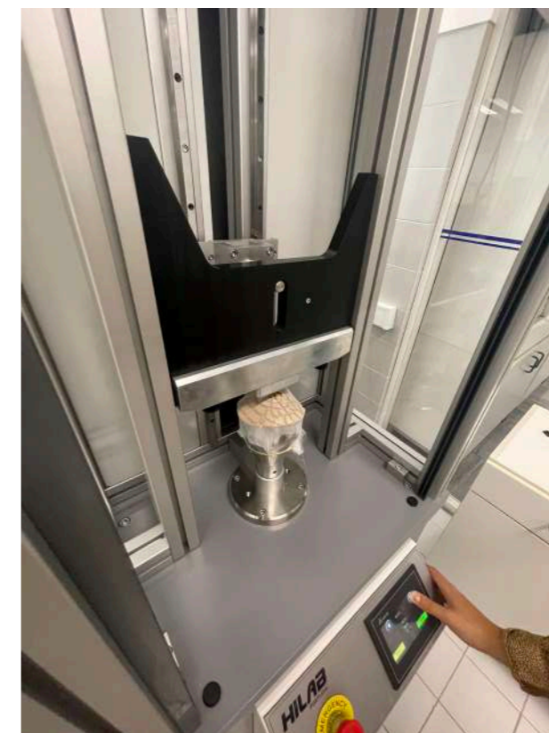
Fig. 40 - Ensaio ao impacto do conceito B com o material desenvolvido no CITEVE. Realizado pelo CITEVE.
