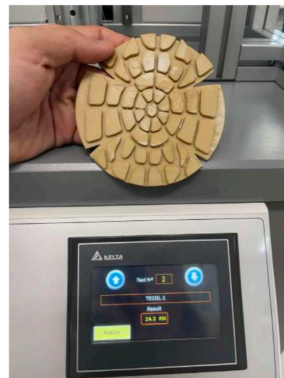
Fig. 43 - 1º Ensaio ao impacto do conceito B com o material desenvolvido no CITEVE. Realizado pelo CITEVE.
