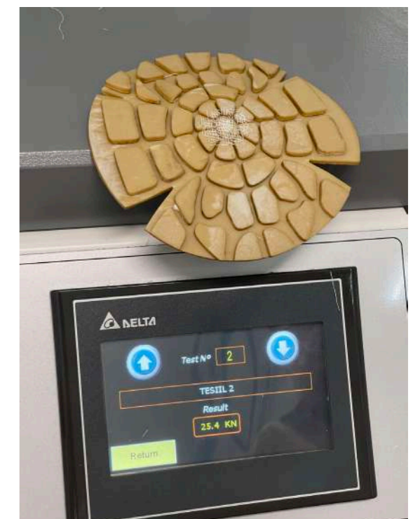
Fig. 44 - 2º Ensaio ao impacto do conceito A com o material desenvolvido no CITEVE. Realizado pelo CITEVE.
