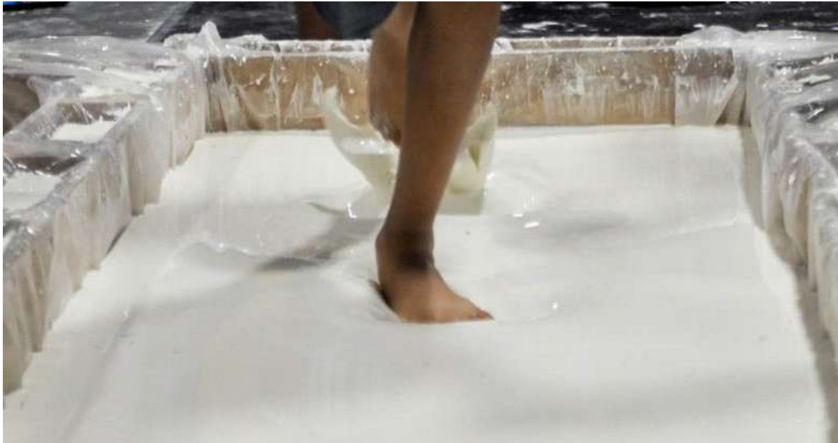
Fig. 3- Exemplo de funcionamento de um fluido não-newtoniano. Retirado de: http://gmdsol.com/el-liquido-que-a-veces-se-comporta-como-un-solido/
