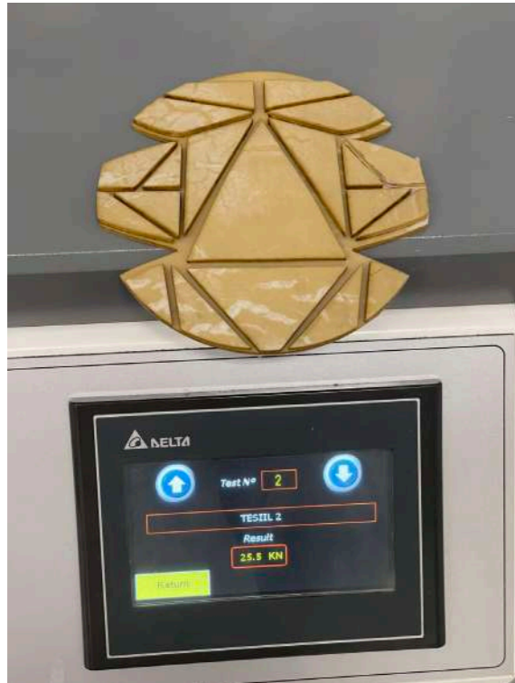
Fig. 45 - 1º Ensaio ao impacto do conceito C com o material desenvolvido no CITEVE. Realizado pelo CITEVE.
