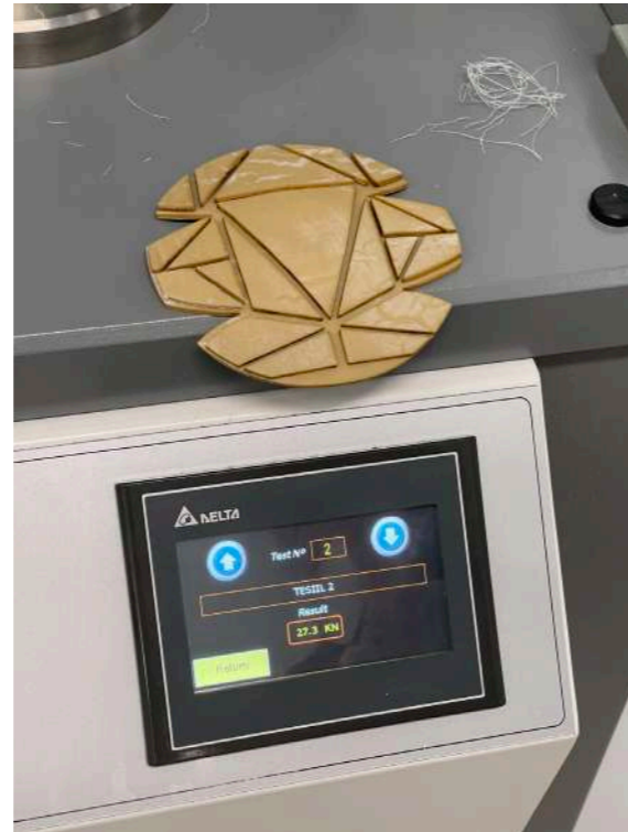
Fig. 46 - 2º Ensaio ao impacto do conceito C com o material desenvolvido no CITEVE. Realizado pelo CITEVE.
