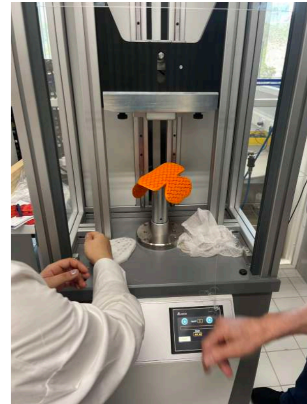
Fig. 39 - Ensaio ao impacto numa peça D30. Realizado pelo CITEVE.
