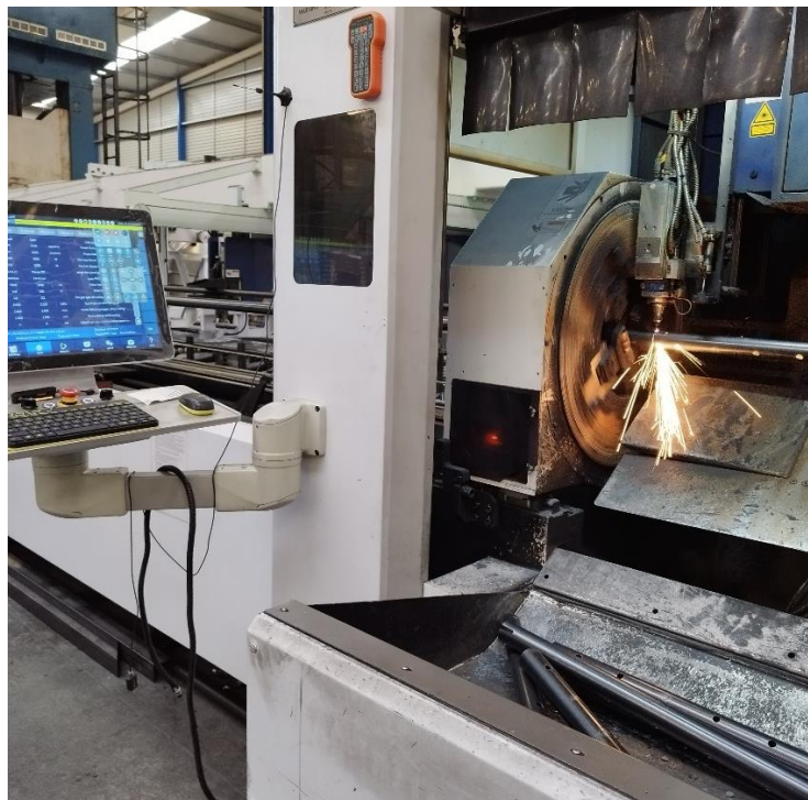
Figura 4.44 – Produção do componente na máquina de corte a laser.
