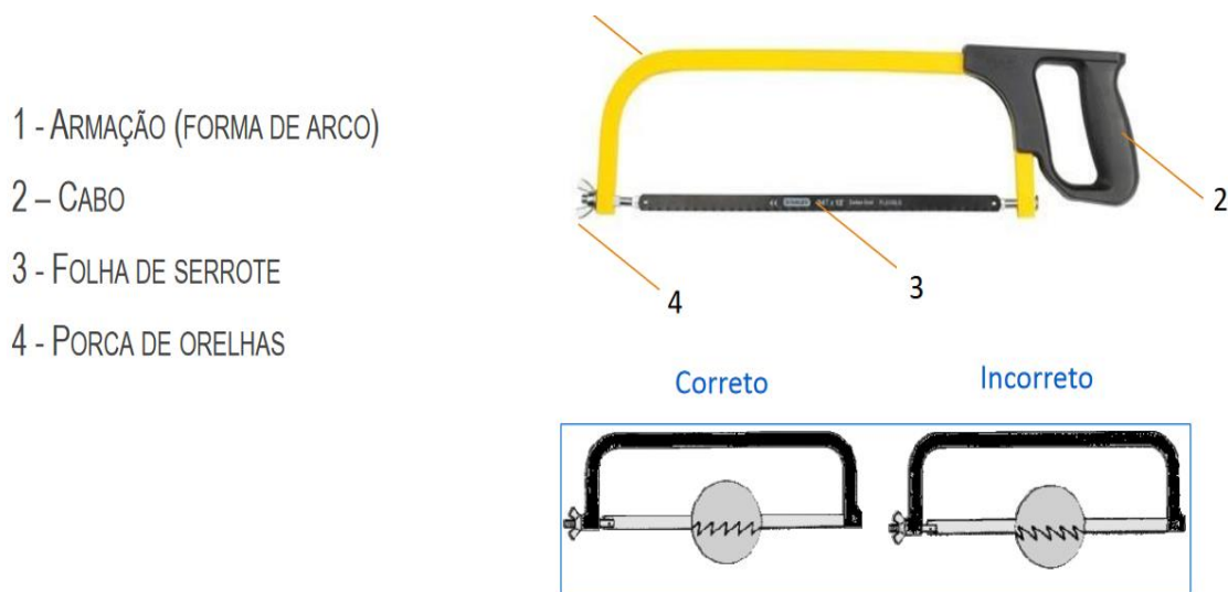
Figura 4.13 – Constituição de um serrote manual.
