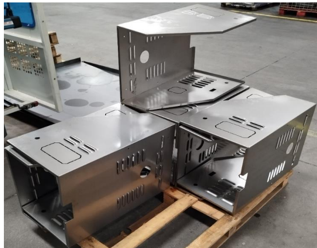
Figura 3.11 – Aplicação Quinadora - Capota quinada.
