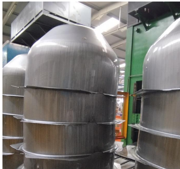
Figura 3.17 – Bocas para baldes.
