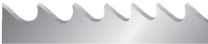
Figura 4.19 – Representação de um passo de serra variável.
