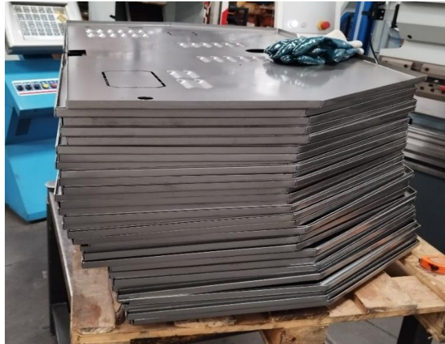
Figura 3.10 – Aplicação Quinadora - Tampa quinada.
