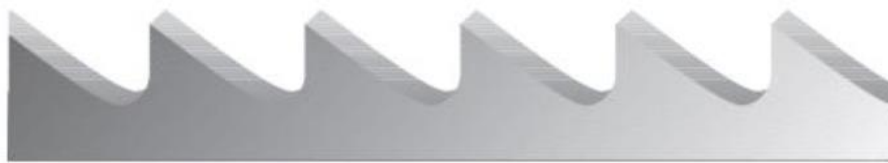
Figura 4.18 – Representação de um passo de serra constante.
