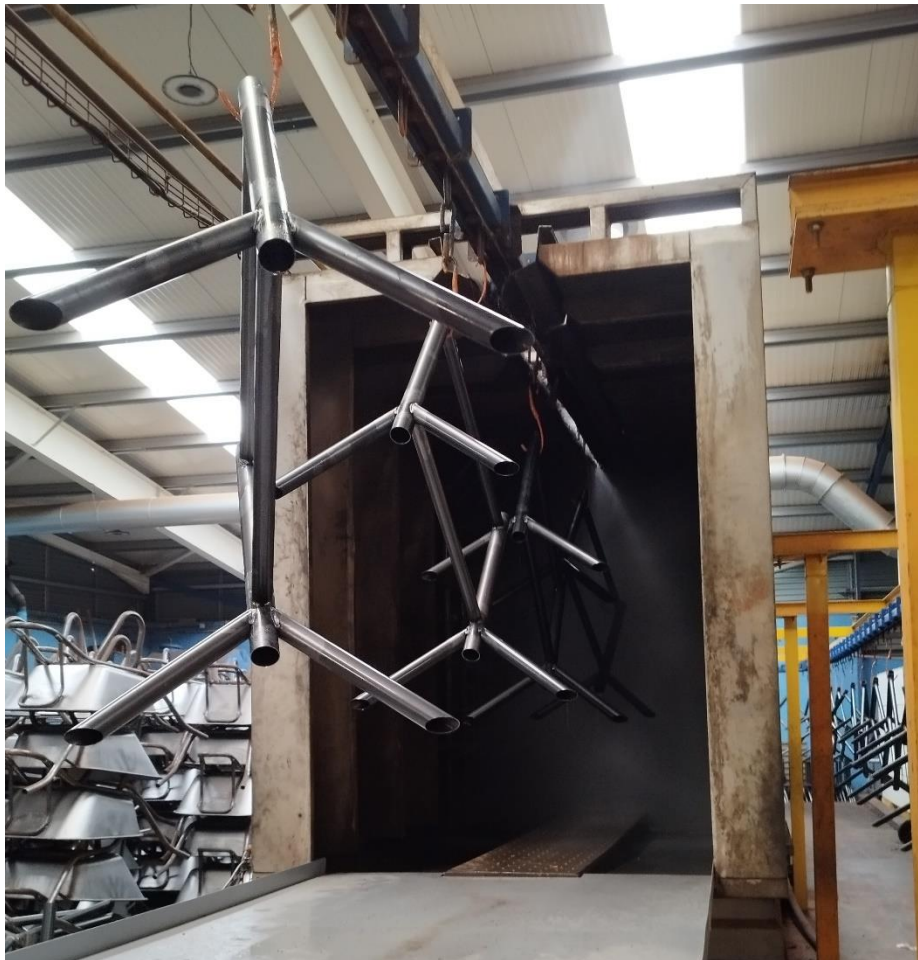
Figura 3.24 – Lavagem dos componentes a pintar.
