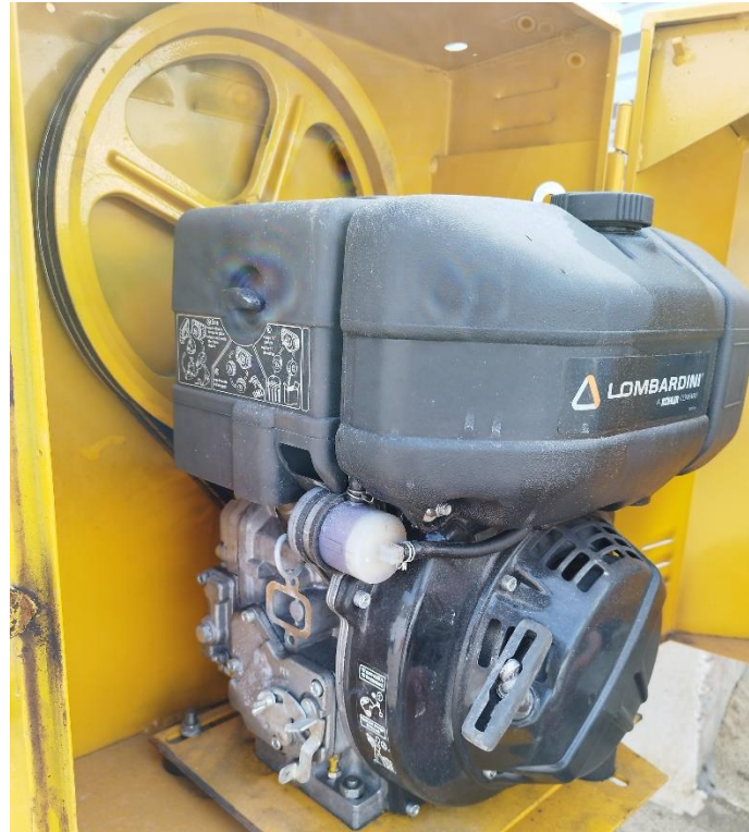
Figura 5.4 – Exemplo do uso de uma correia como elemento de transmissão de potência.
