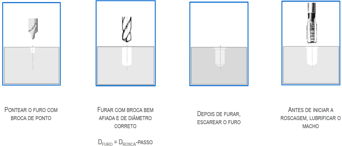
Figura 4.27 – Procedimento de abertura de roscas.
