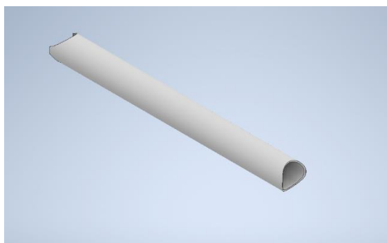
Figura 4.42 – Curva do braço de uma betoneira - Representação CAD.
