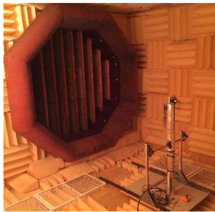
Figura 2.21 - Instalação da bancada de testes, na câmara de testes, adaptado de (Borges, 2015).
