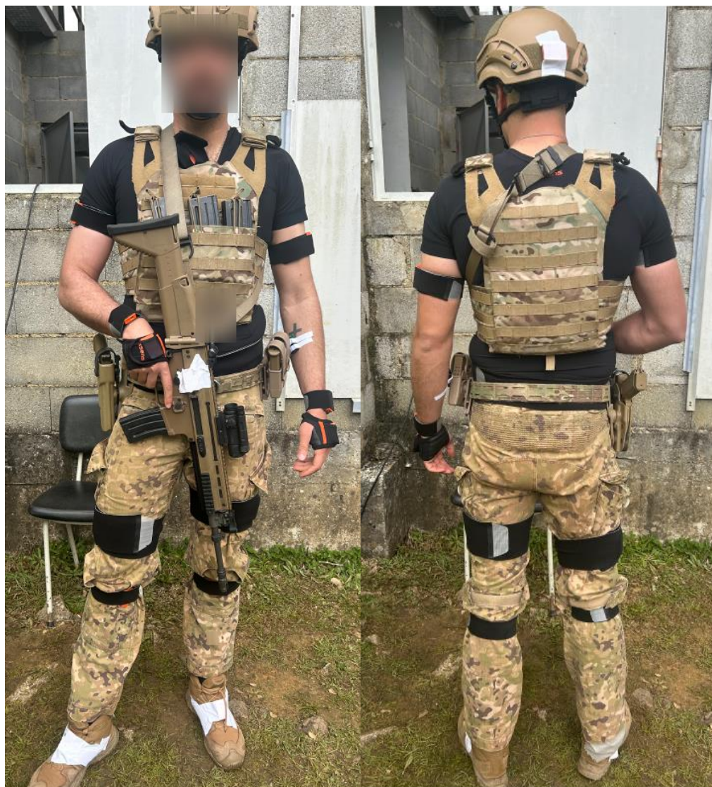
Figura n.º 6 – Posição dos Sensores Inerciais (IMUs) no Participante
