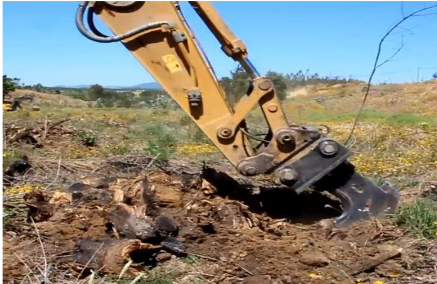
Figura 5 Giratória (braço) acoplada com enxó a destroçar cepos de eucalipto e a covear entre cepos
