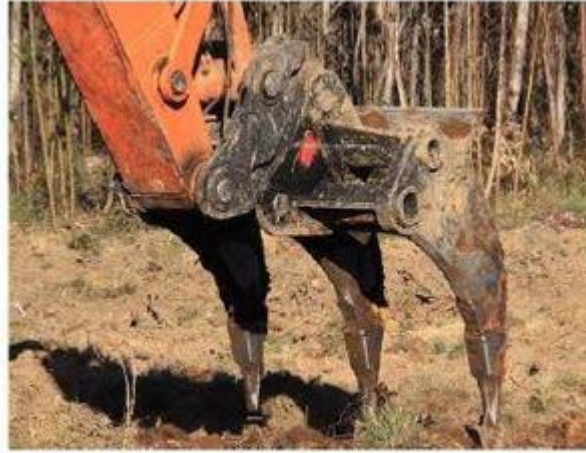
Figura 4 Giratória (braço) acoplada com ríper de 3 dentes (tririper)
