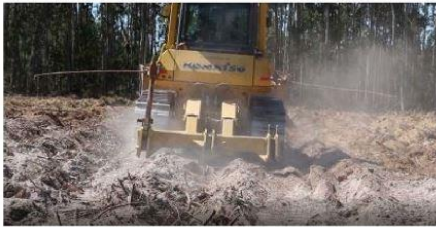
Figura 3 Ripagem com 1 ferro (1 dente de riper), após a realização de uma gradagem total / contínua em toda a área
