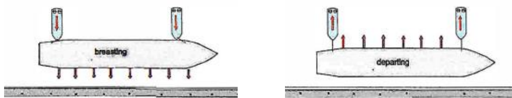
Figura 37 – Atracar e desatracar utilizando o modo de puxar- empurrar Fonte: (Hensen, 2018)
