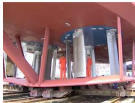
Figura 12 – Sistema de propulsão cicloidal Fonte: (Jürgens & Heinke, 2009)
