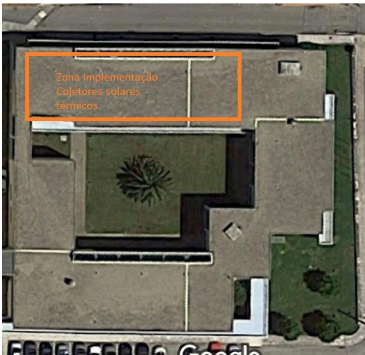
Figura 6- Localização coletores solares térmicos
