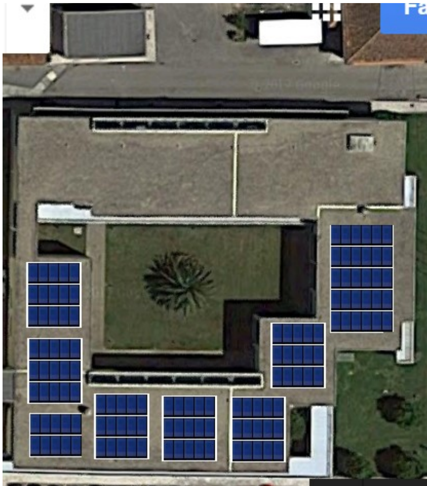
Figura 45- Implementação de 130 módulos solares fotovoltaicos
