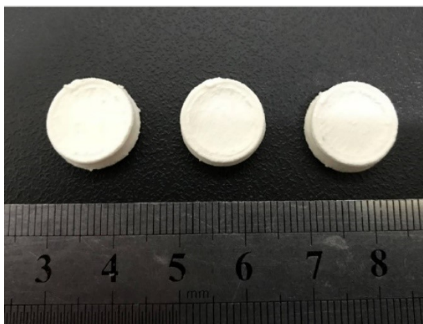
Figura 7: Sistemas gastro retentivos impressos (modelo 1, modelo 2 e modelo 3) (Wen et al., 2019)
